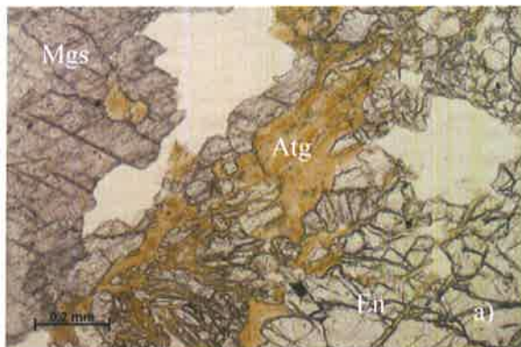
Slika 13. Mikroskopski uzorak SAG 1, a) bez analizatora, b) s analizatorom ( Atg – antigorit, Mgs – Magnezit, En – enstatit)
