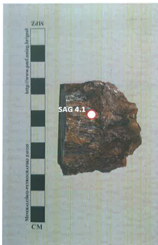
Slika 8: Makroskopski izgled uzorka SAG 4 korištenog za analizu u ovom radu (crveni kružić označava mjesto s kojeg je uzet uzorak za XRPD analizu SAG 4.1)
