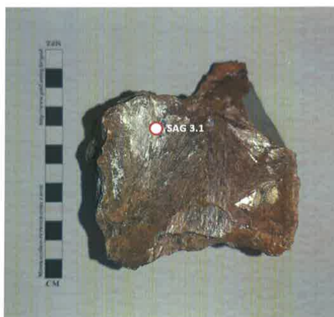
Slika 7): Makroskopski izgled uzorka SAG 3 korištenog za analizu u ovom radu (crveni kružić označava mjesto s kojeg je uzet uzorak za XRPD analizu SAG 3.1)
