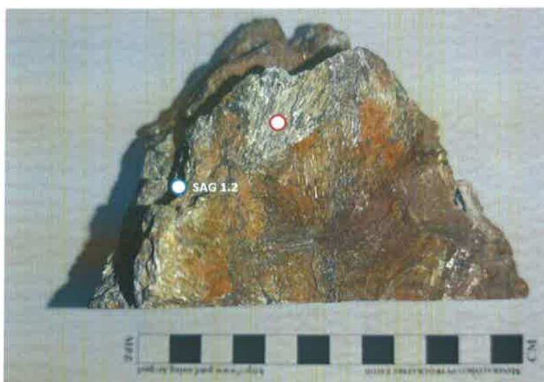
Slika 5: Makroskopski izgled uzorka SAG 1 korištenog za analizu u ovom radu (crvena kružić označava mjesto s kojeg je uzet uzorak za XRPD analizu SAG 1.1; plavi kružić označava mjesto s kojeg je uzet uzorak za XRPD analizu SAG 1.2)
