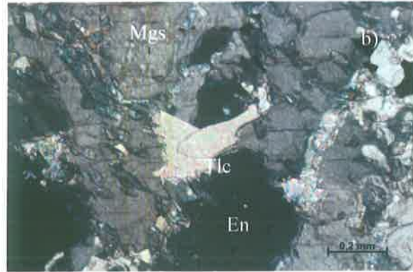
Slika 23. Mikroskopski uzorak SAG 3, a) bez analizatora, b) s analizatorom ( En – enstatit, Tlc – talk, Mgs – magnezit )
