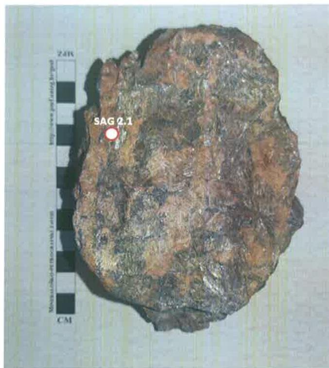
Slika 6): Makroskopski izgled uzorka SAG 2 korištenog za analizu u ovom radu (crveni kružić označava mjesto s kojeg je uzet uzorak za XRPD analizu SAG 2.1)
