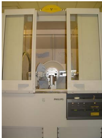
Slika 18 - Philips PW3040/60 X'Pert PRO difraktometar na mineraloško petrografskom zavodu PMF-a
