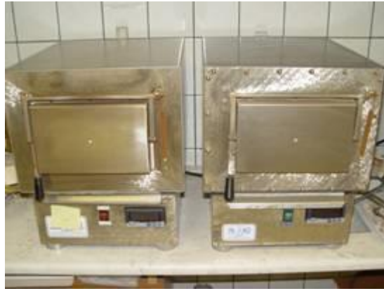
Slika 19 - Inko/ LP 08 peći za žarenje na Mineraloško petrografskom zavodu PMF-a
