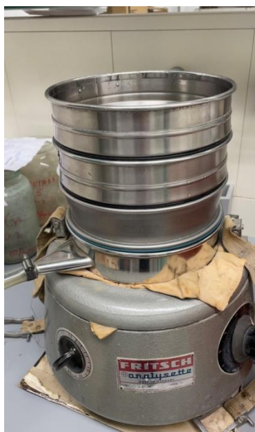
Slika 5: Tresilica i dio seta sita za mokro sijanje.
