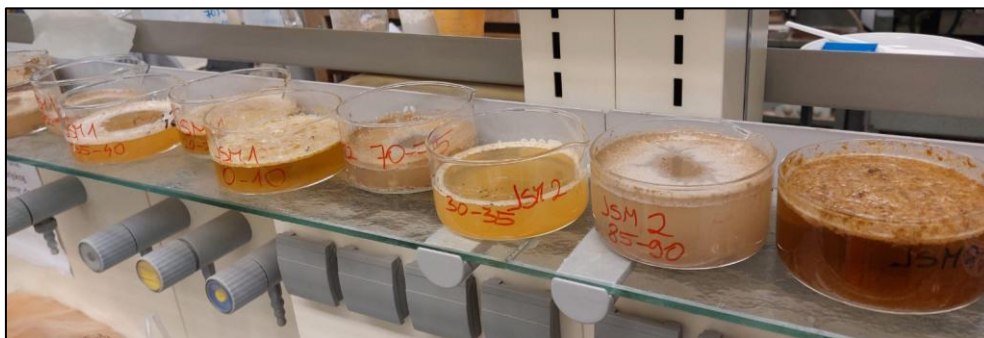
Slika 14. Reakcija uzoraka nakon miješanja s 30%-tnom otopinom vodikovog peroksida
