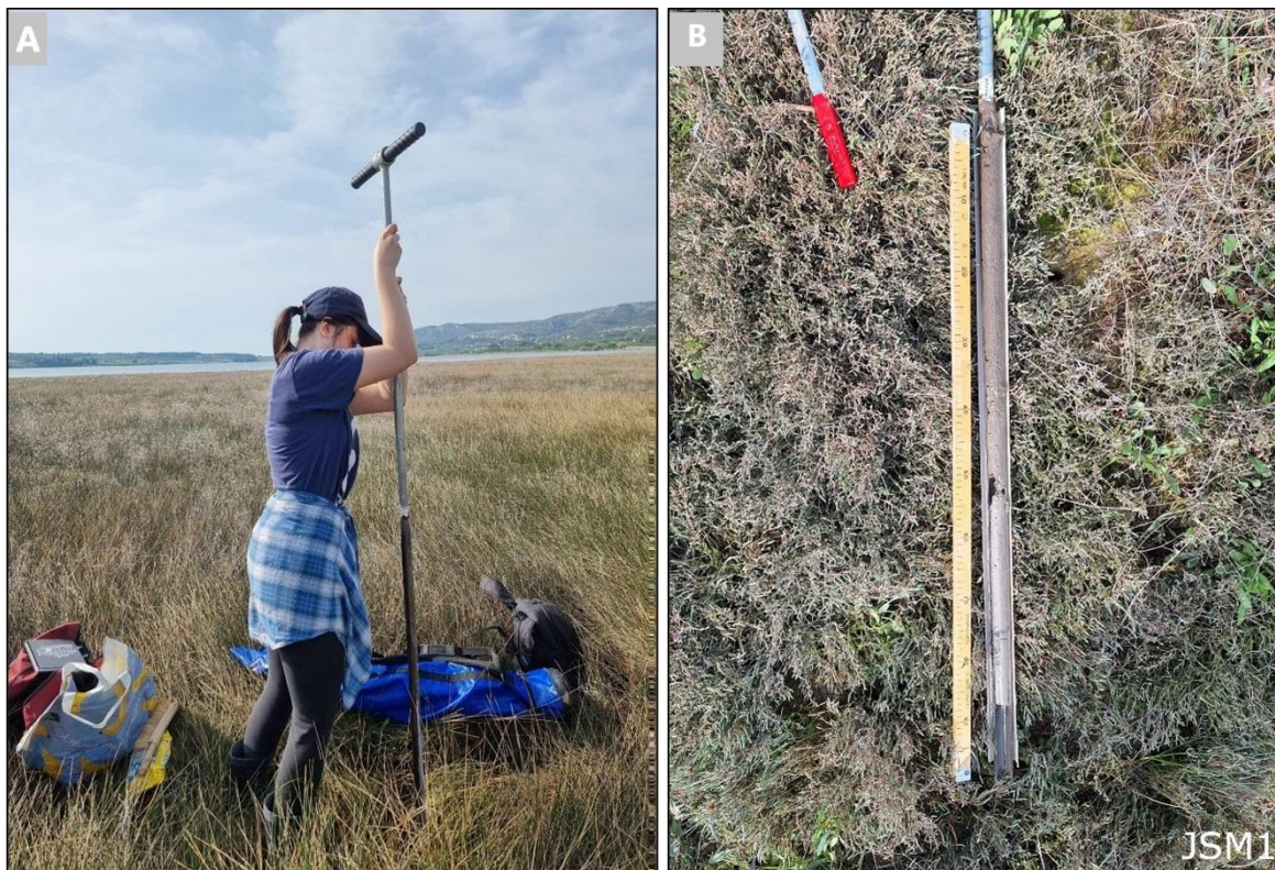
Slika 5. a) proces bušenja jezgre b) prikaz izvađene jezgre JSM1
