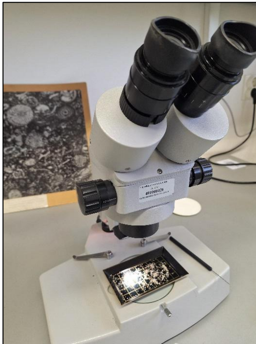
Slika 12. Stereoskopski mikroskop, plitica i iglica za mikroskopiranje
