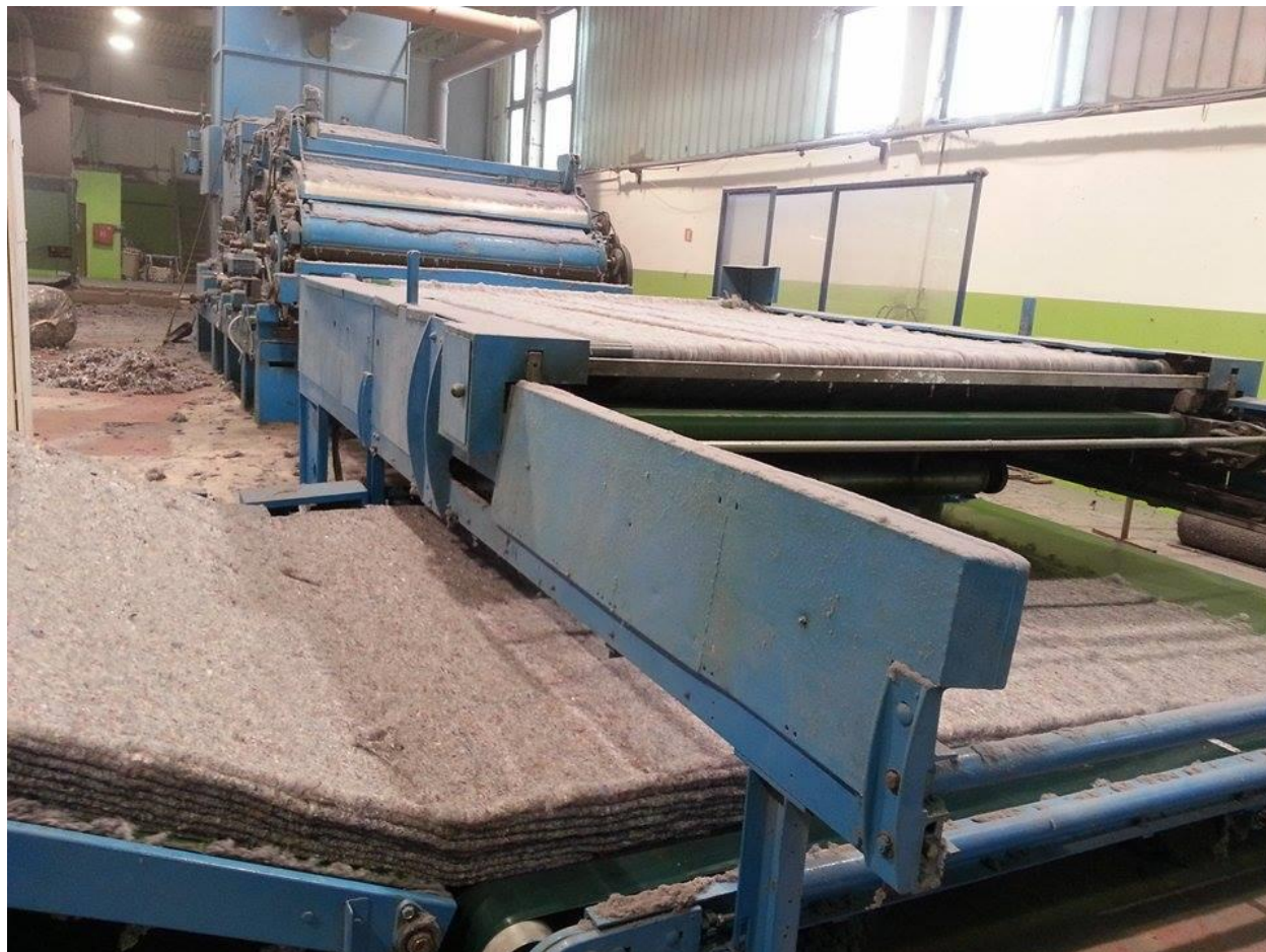
Slika 13. Učvršćivanje različitih filčeva
