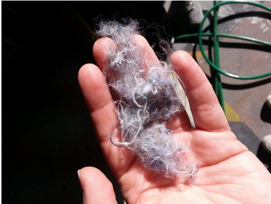
Slika 11. Pomiješani tekstil sa bijelom komponentom za poboljšanje svojstava.
