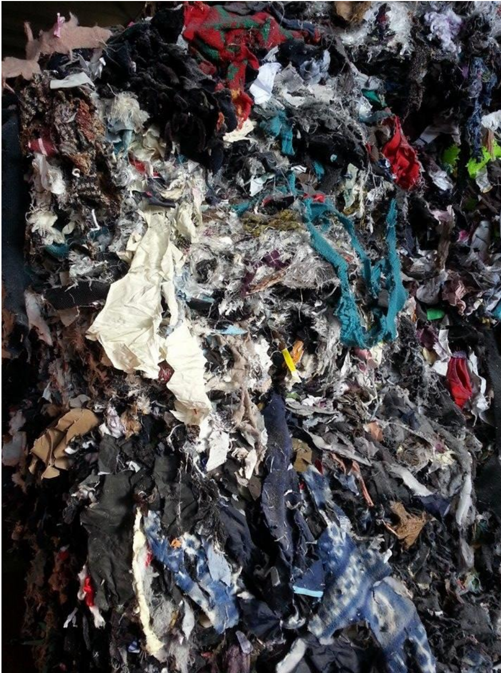
Slika 8. Poluproizvod nastao mješanjem tehničkog tekstila sa usitnjenim odjevnim predmetima.
