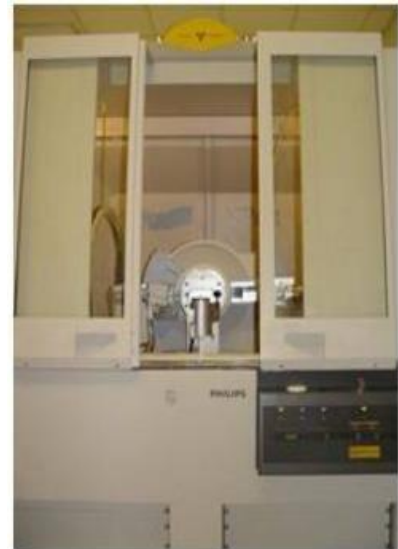
Slika 18. Rendgenski difraktometar Phillips X'Pert Pro, Mineraloško-petrografski zavod.
