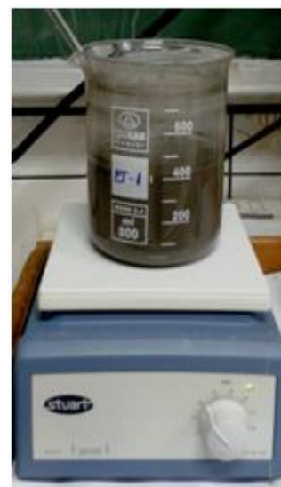
Slika 21. Suspenzija uzorka na magnetnoj miješalici.
