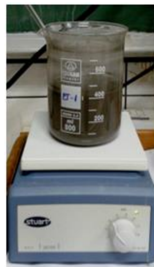
Slika 21. Suspenzija uzorka na magnetnoj miješalici.
