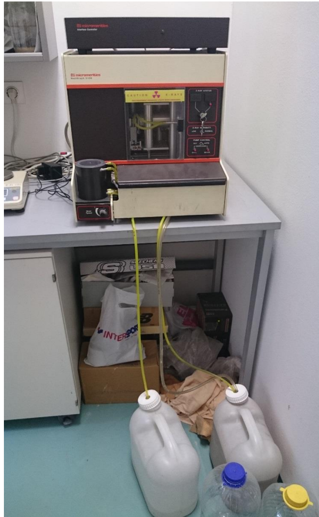
Slika 8. SediGraph 5100, Geološko-paleontološki zavod PMF-a.
