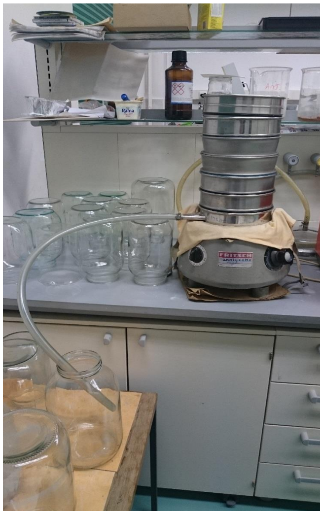
Slika 7. Set Retsch® ASTM sita pričvršćenih na tresilicu Fritsch Analysette®, Geološko-paleontološki zavod PMF-a.
