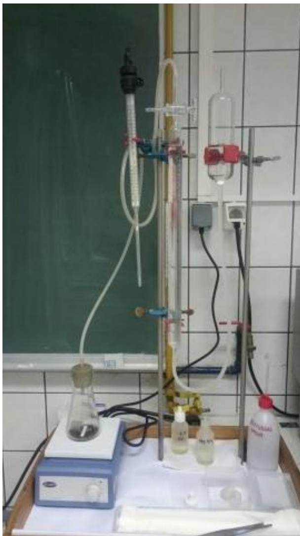
Slika 9. Scheiblerov kalcimetar, Mineraloško-petrografski zavod PMF-a.
