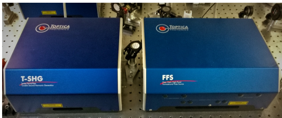
Slika 4.1: Femtosekundni laser (desno) te jedinica za generiranje drugog harmonika (lijevo).
