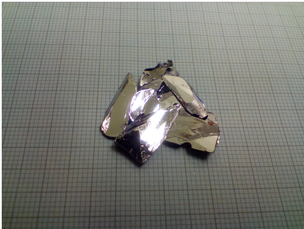
Slika 5.5: Raskomadani izrasli polikristal BiSbTe_2S . Iako nismo dobili lijep mono-kristal, kao i za BiSbTeSe_2 prikazan na predhodnoj slici, nakon lomljenja kristala dobiveno je nekoliko sjajnih uzoraka pogodnih za pripremu.
