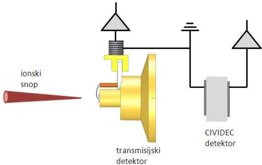
**Slika 5.10:** Shematski prikaz mjernog postava u  $\Delta E$ - $E$  konfiguraciji koju čine transmisijski dijamantni detektor i komercijalni CVIDEC-ov dijamantni detektor.
