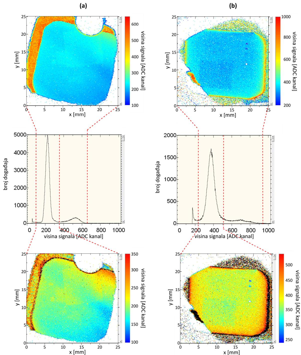
**Slika 5.9:** IBIC mape: (a) transmisijskog i (b) membrana2 detektora snimljene 1,3 MeV-skim protonima. U sredini su prikazani cijelokupni spektri induciranih nabojnih signala. Na vrhu su mape sa skalom koja obuhvaća cijelo spektralno područje, a na dnu mape s finijom skalom koja odgovara signalima iz glavnih vrhova u spektrima. Crvene isprekidane linije označuju dio spektra koji je prikazan na pojedinoj mapi.
