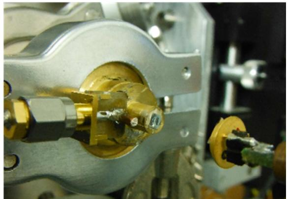
**Slika 5.13:** Transmisijski dijamantni detektor pričvršćen na vakuumsku komoru mikroprobne linije. (a) Snimak iz daljine. (b) Pogled izbliza. Nasuprot dijamantnog detektora nalazi se PIN dioda.
