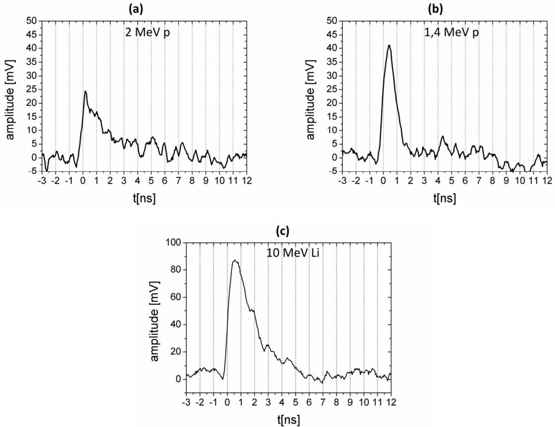
**Slika 5.16:** Signali (a) protona energije 2 MeV, (b) protona energije 1,4 MeV i (c) litijevih iona energije 10 MeV snimljeni u spoju sa širokopojasnim prepojačalom CIVIDEC, frekventnog raspona 2 GHz i osciloskopom LeCroy, frekventnog raspona 5 GHz.
