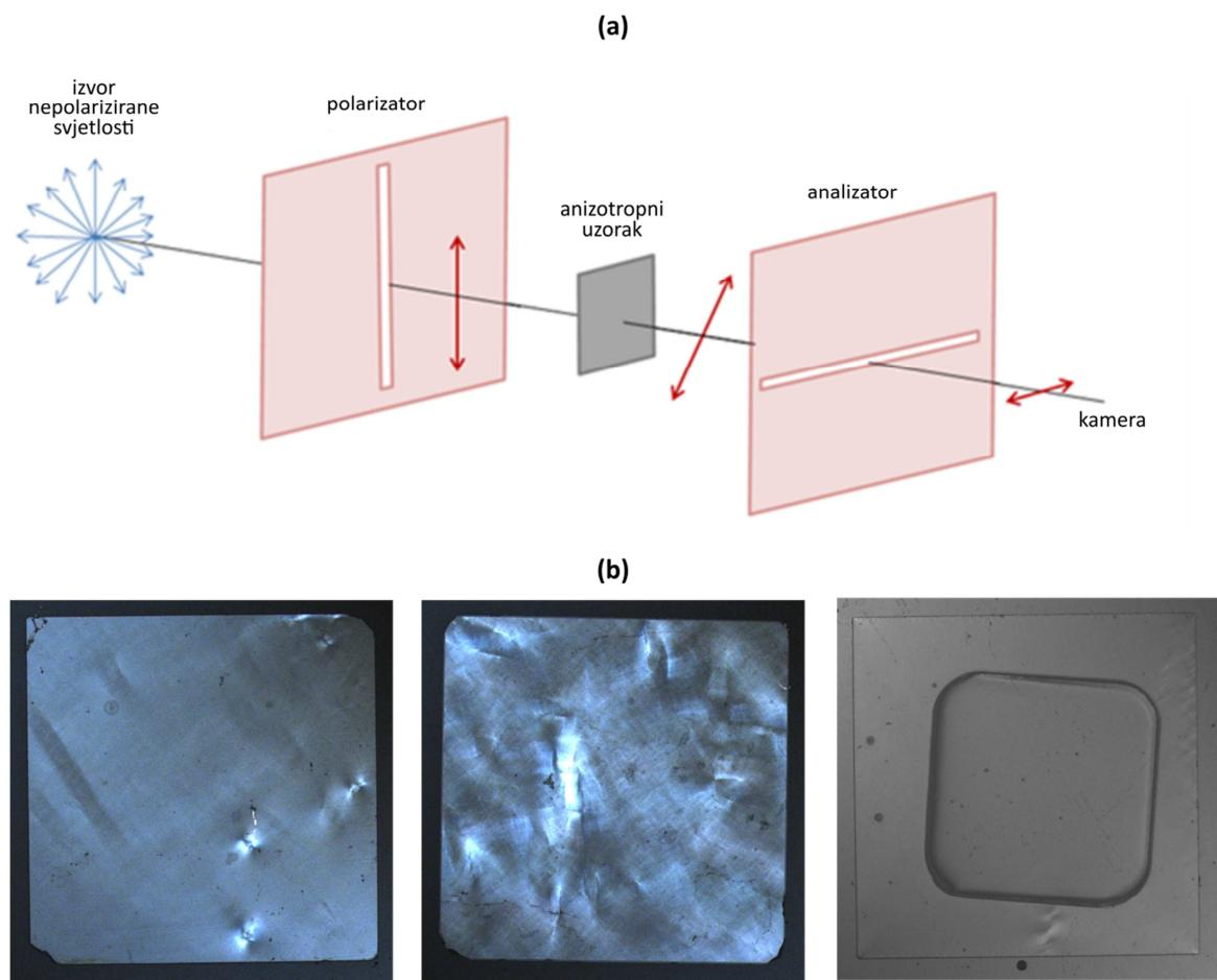
**Slika 4.3:** (a) Osnove mjerjenja optičke anizotropnosti metodom okomito polarizirane svjetlosti. (b) Različiti dijamantni kristali snimljeni kroz okomite polarizatore (vidi tekst).
