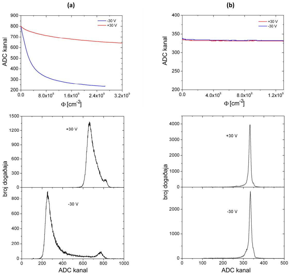
**Slika 6.11:** Razvoj polarizacije u neoštećenim dijelovima transmisijskog detektora za upadne ione ugljika energija (a) 1,8 MeV i (b) 12 MeV. Gornji grafovi prikazuju medijane za svakih 1000 događaja, a donji grafovi ukupne spektre na  $\pm 30$  V. Na x-osi u spektrima prikazan je broj kanala ADC-a.
