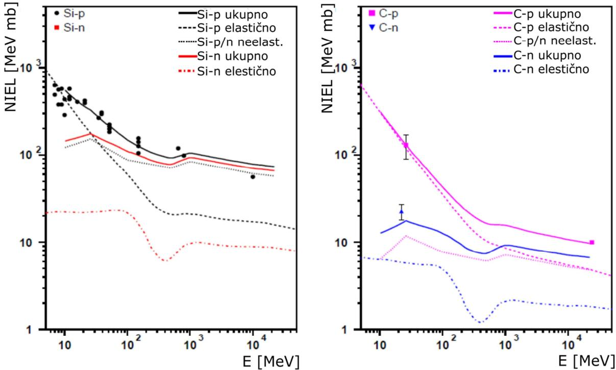
**Slika 6.2:** NIEL udarni presjek u siliciju (lijevo) i dijamantu (desno) za protone i neutrone kao funkcija upadne energije. Naznačeni su i zasebni doprinosi od eleštičnih i neelastičnih raspršenja. Preuzeto iz [63].
