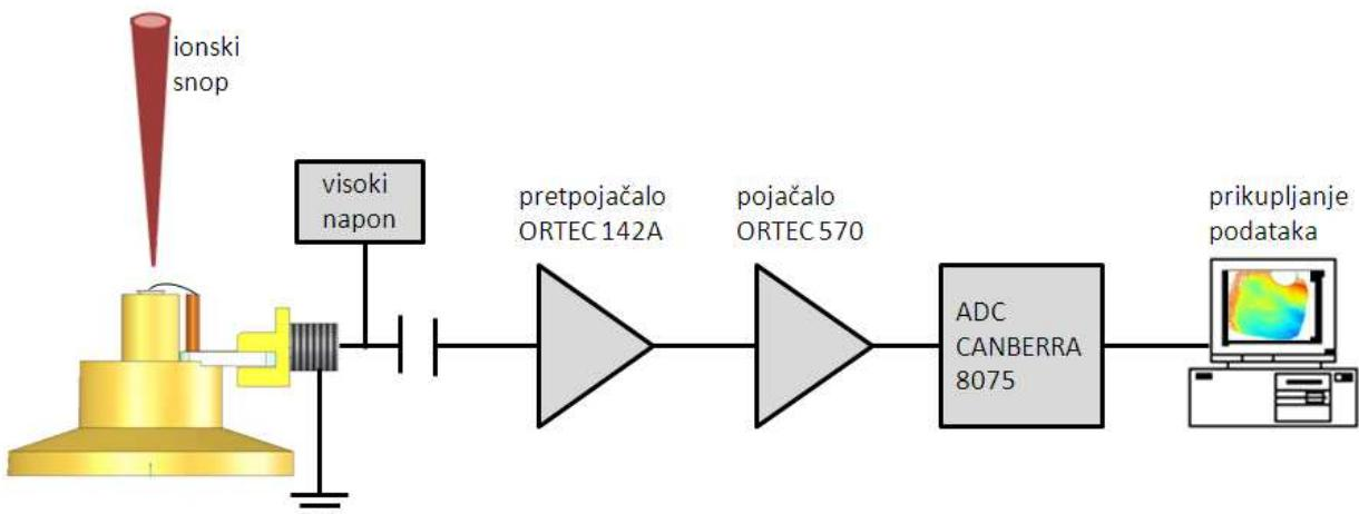
Slika 5.8: Shematski prikaz elektroničkog lanca za IBIC analizu.
