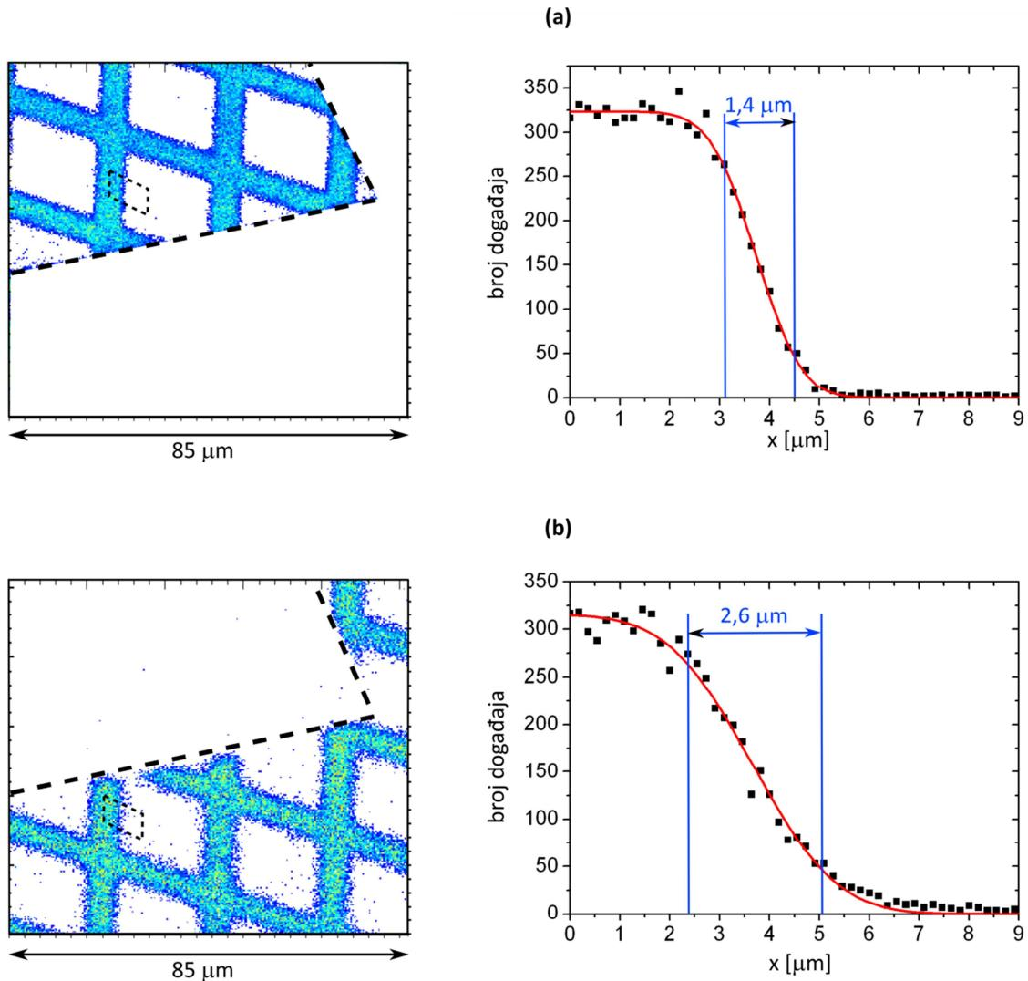
**Slika 5.4:** STIM slika bakrene mrežice (dimenzija ćelije 25 μm) ozračene mikro-snopom protona energije 2 MeV. (a) Protoni prolaze izravno kroz mrežicu. (b) Protoni prvo prolaze kroz dijamantnu membranu. Deblja isprekidana linija na slikama lijevo prikazuje granicu slomljene membrane. Tanke isprekidane linije označavaju područja iz kojih su projekcijom na x-os dobivene raspodjele broja događaja prikazane desno.
