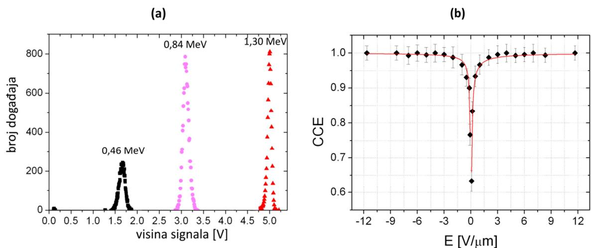
**Slika 5.11:** (a) Signali 1,3 MeV-skih protona u transmisijskom detektoru (crni kvadratići) te CVIDEC detektoru pri direktem upadu (crveni trokutići) i nakon prolaska kroz transmisijski detektor (ljubičaste točke). (b) Ovisnost CCE o električnom polju u transmisijskom detektoru. Crvene linije prikazuju prilagodbu na (5.9).
