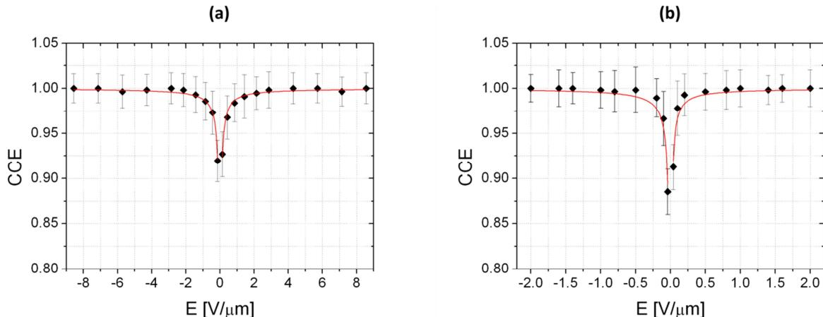
**Slika 5.12:** Ovisnost CCE o električnom polju u (a) membranu2 detektoru i (b) scCVD dijamantnom detektoru debljine  $50 \mu\text{m}$ . Crvene linije prikazuju prilagodbu na (5.9).
