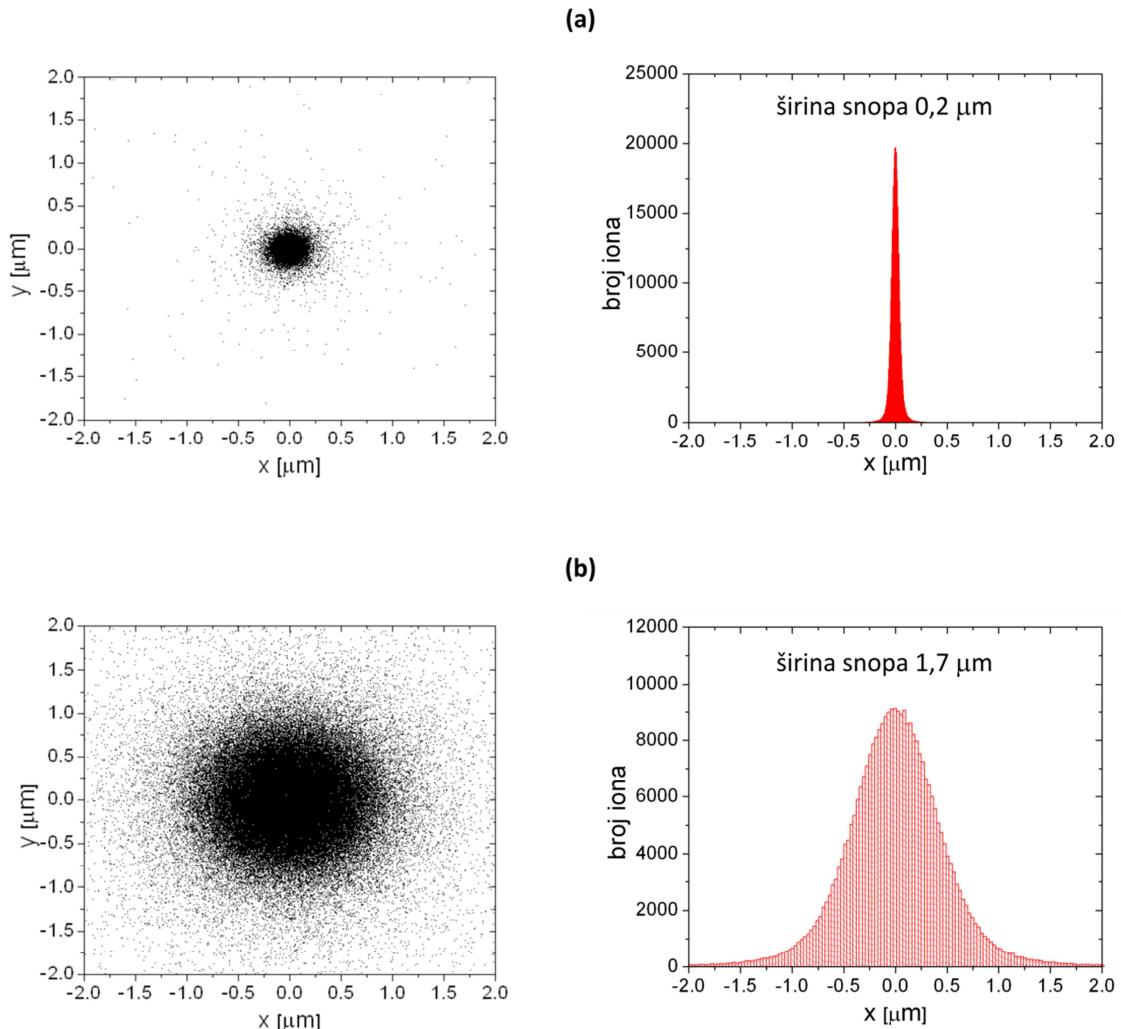
**Slika 5.3:** Simulacija lateralne raspodjela 2 MeV-skih protona: (a) neposredno poslije i (b)  $150 \mu\text{m}$  nakon prolaska kroz  $6 \mu\text{m}$  debeli sloj dijamanta. Lijevo su prikazani konačni položaji svakog od 300000 simuliranih iona u SRIM-u. Desno su projekcije broja iona na x-os.
