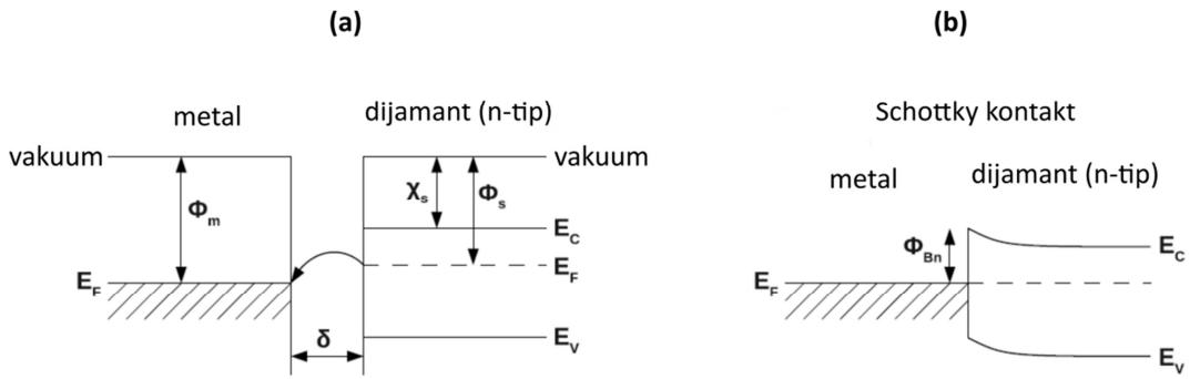
**Slika 3.6:** Shematski prikaz razvoja Schottky barijere  $\Phi_{Bn}$  na granici metala i dijamanta. Prikazani su energijski nivoi prije (a) i nakon (b) ostvarivanja kontakta.  $\Phi_m$  označava radnu funkciju metala, a  $\chi_s$  elektronski afinitet dijamanta.  $\Phi_{Bn}$  odgovara razlici te dvije veličine. Preuzeto iz [35].
