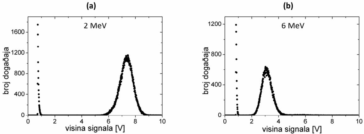
**Slika 5.15:** Spektri protona energije (a) 2 MeV i (b) 6 MeV, snimljeni transmisijskim detektorom na mjestu vakuumskog prozora. Korišteno je naboјno pojačalo COOLFET A250CF.
