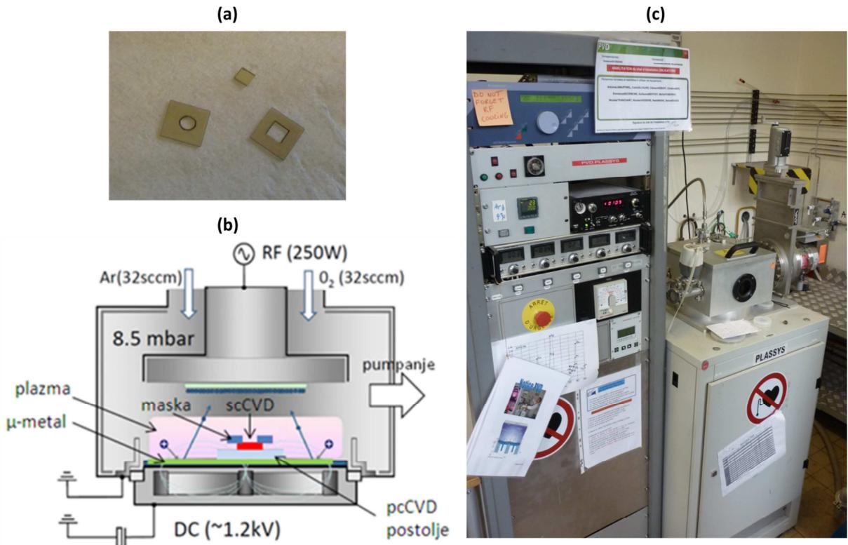
**Slika 4.2:** (a) Neke od korištenih maski za prekrivanje uzorka pri jetkanju. (b) Shematski prikaz unutrašnjosti PLASSYS uređaja tijekom jetkanja dijamanta. (c) PLASSYS uređaj na institutu CEA u Saclay-u.
