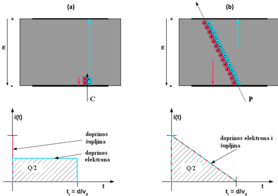
**Slika 3.3:** Prikaz vremenskog razvoja induciranih signalova za slučaj iona kratkog dosega (a) i iona koji prolazi kroz cijelu debljinu detektora (b).
