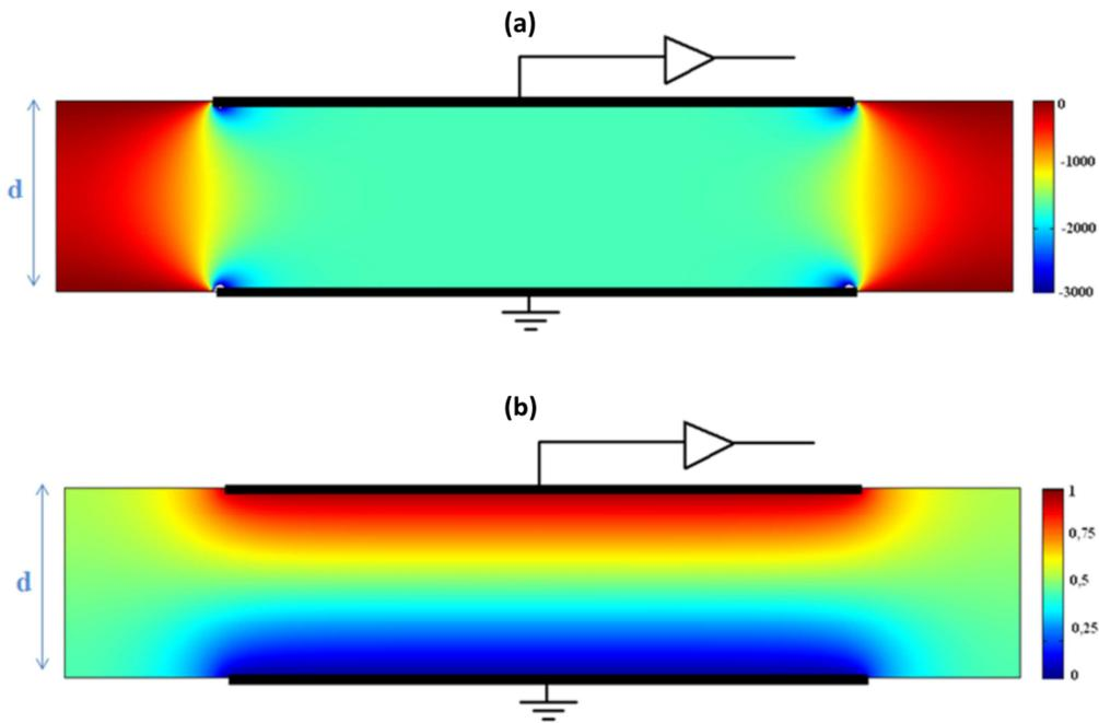
**Slika 3.4:** Poprečni presjeci težinskog polja (a) i težinskog potencijala (b) u dijamantnom detektoru simulirani programskim paketom COMSOL. Za izradu je pretpostavljena širina dijamantnog kristala od 3 mm, od čega je 2 mm metalizirano. Za debljinu detektora radi jasnjeg prikaza uzeto je  $d = 600 \mu\text{m}$ , iako su u radu korišteni detektori debljine 50 i 6 μm.
