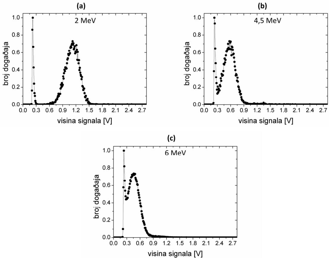
**Slika 5.14:** Spektri protona energije (a) 2 MeV, (b) 4,5 MeV i (c) 6 MeV, snimljeni transmisijskim detektorom na mjestu vakuumskog prozora. Korišteno je naboјno pojačalo ORTEC 142a.
