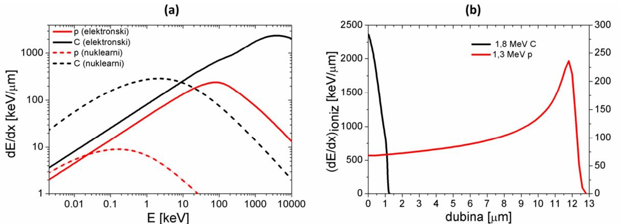
**Slika 3.2:** (a) Elektronska i nuklearna zaustavna moć protona i ugljikovih iona u dijamantu za raspon energija od 1 eV do 10 MeV. (b) Gubitak energije ionizacijom u ovisnosti o dubini u dijamantu za 1,3 MeV-ske protone i 1,8 MeV-ske ione ugljika.
