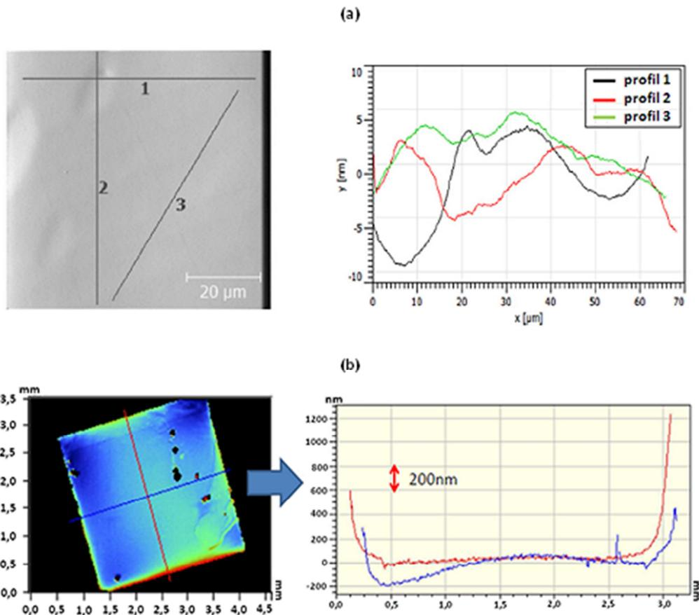
**Slika 4.4:** (a) Hrapavost površine scCVD dijamanta nakon jetkanja Ar/O<sub>2</sub> plazmom, snimljena AFM-om. Lijevo je 2D mapa a desno odgovarajući profili za linije naznačene na mapi. (b) 2D slika dijamantne membrane napravljena optičkom interferometrijom (lijevo) te topografski profili duž dva međusobno okomita smjera.
