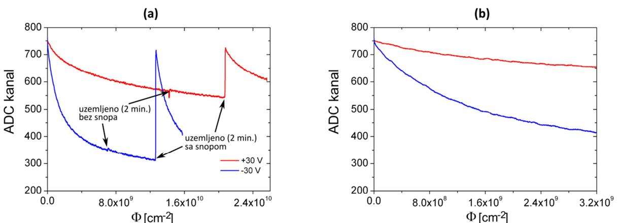
**Slika 6.12:** (a) Razvoj polarizacije u neoštećenom dijelu membrana2 detektora za ione ugljika energije 1,8 MeV te depolarizacija na način opisan u tekstu. (b) Podaci iz (a) dijela na finijoj skali radi usporedbe s podacima na slici 6.11a.
