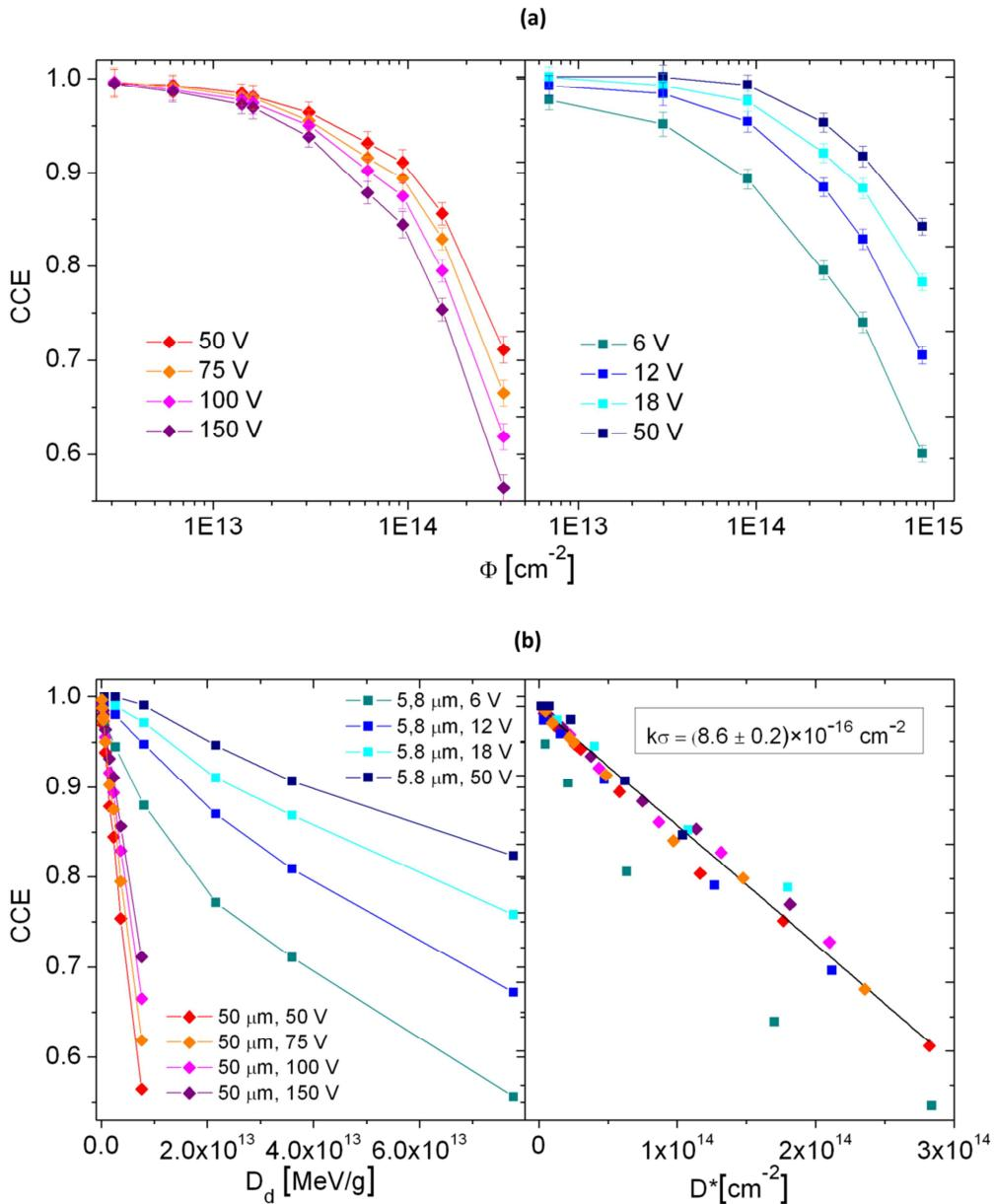
**Slika 6.8:** (a) Ovisnost CCE o integriranim toku 4,5 MeV-skih protona u 50-mikrometarskom dijamantnom detektoru (lijevo) i 1,3 MeV-skih protona u transmisijskom detektoru (desno) na raznim električnim poljima. (b) Degradacija CCE s ukupnom dozom neionizacijske energije kod oba dijamantna detektora (lijevo) i prilagodba podataka na izraz (6.13) (desno).
