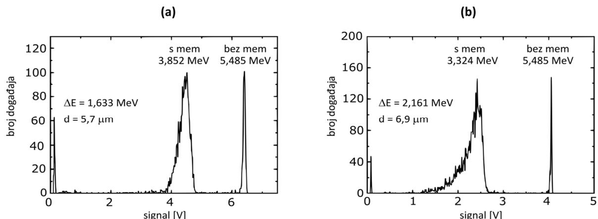
**Slika 5.2:** Spektri  $\alpha$ -čestica iz  $^{241}\text{Am}$  u silicijskom detektoru s i bez membrane ispred detektora. (a) Membrana iz transmisijskog detektoru. (b) Membrana iz membrana2 detektoru.
