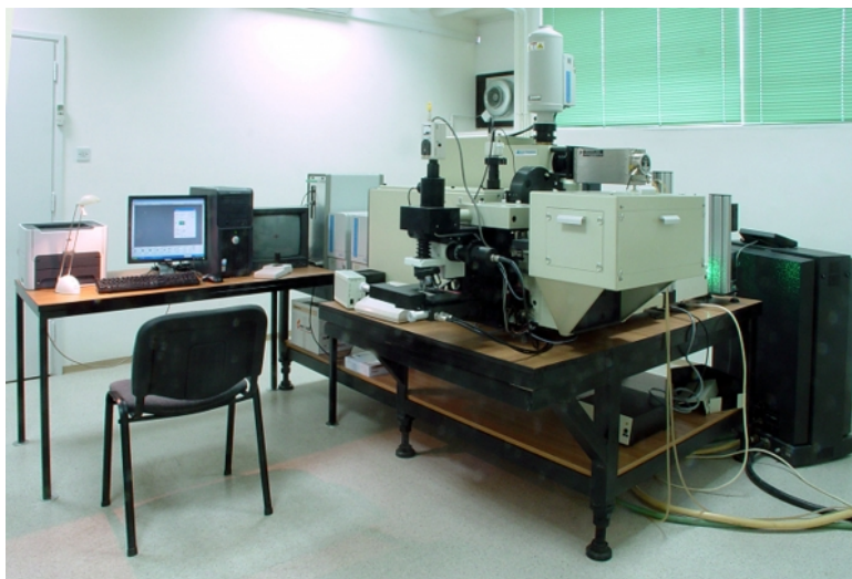
Slika 48. Ramanov spektrometar Horiba Jobin-Yvon T64000, Institut Ruđer Bošković, Zavod za fiziku materijala, Laboratorij za molekulsku fiziku.
