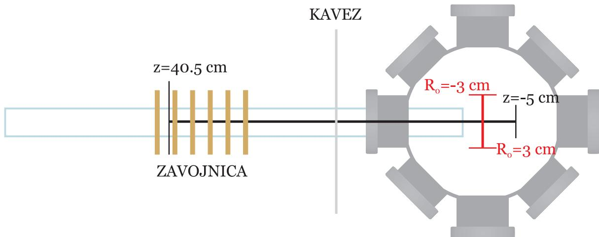
**Slika 5.32:** Pozicije mjerjenja,  $z$  je dimenzija u smjeru osi cijevi, a  $R_0$  je u smjeru okomitom na cijev.
