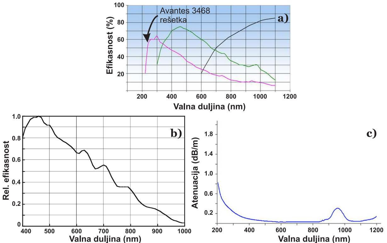
Slika 4.9: a) Efikasnost rešetke za *Avantes AvaSpec 3648* [45] b) Relativna efikasnost *Sony ILX-511* detektora u spektrometru *HR2000* [46] c) Atenuacija signala u optičkom vlaknu (solar resistant fiber).
