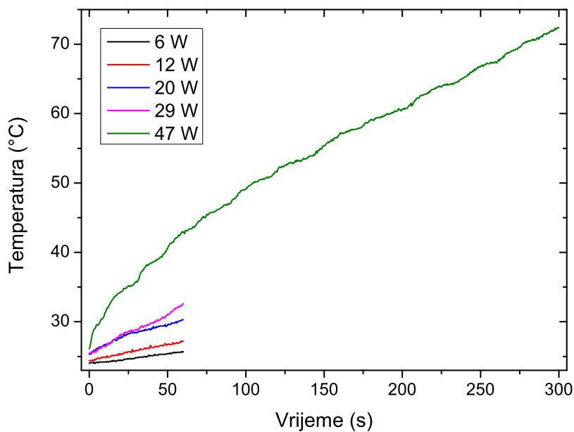
**Slika 5.63:** Temperature HA uzorka prilikom obrade, za različite primjenjene snage.
