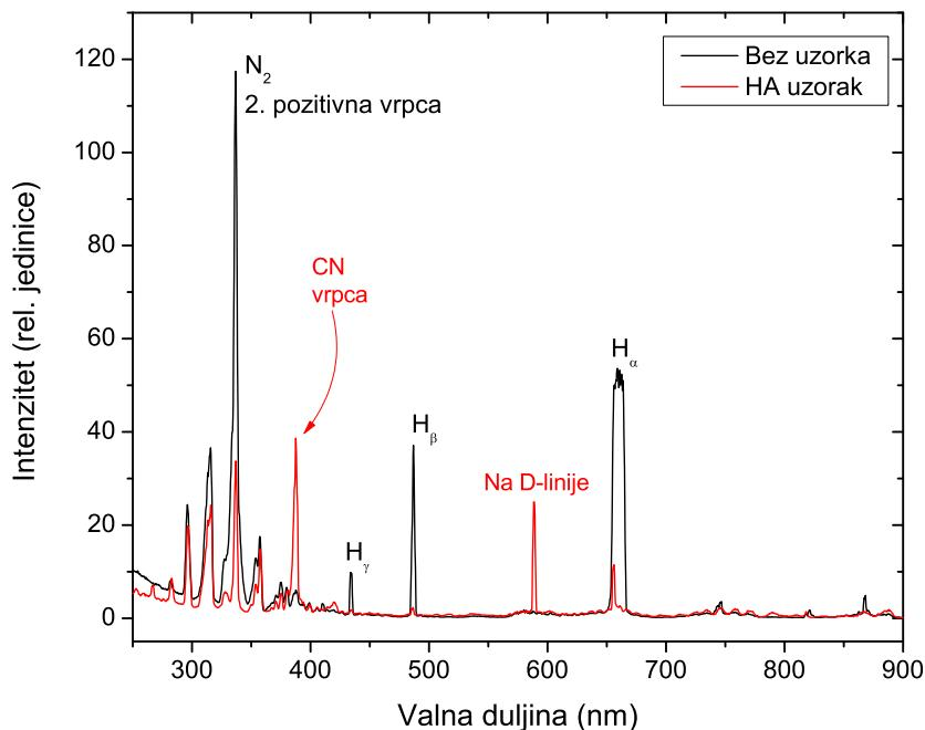
**Slika 5.65:** Spektri u H-modu, pri 550 W, za praznu cijev i prilikom tretmana uzorka, H<sub>α</sub> je u saturaciji.
