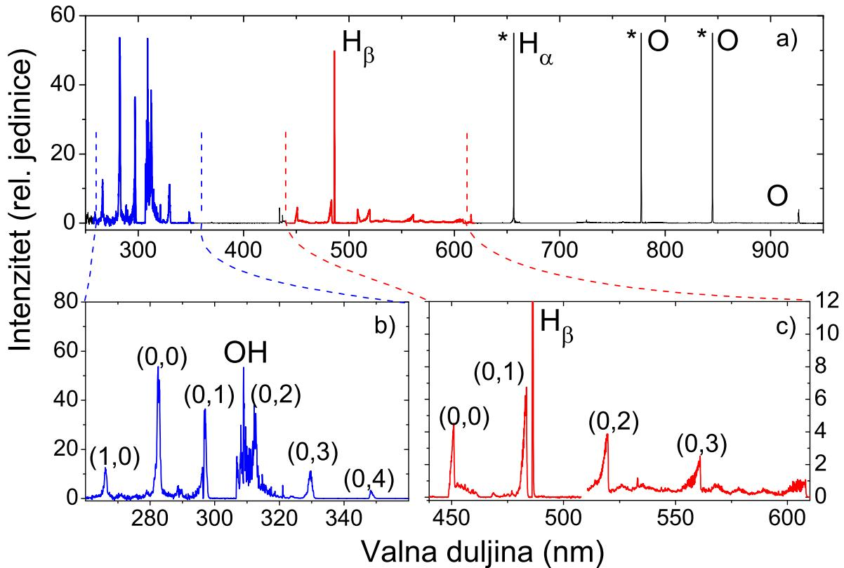
**Slika 5.21:** Spektar O<sub>2</sub> plazme prilikom uklanjanja a:C-H slojeva, tlak plina je 70 Pa, primjenjena snaga je 230 W. Linija označene s \* su u saturaciji. Spektar između 250 i 950 nm (a), dio grafa koji prikazuje OH molekulsku vrpcu ( $A^2\Sigma \rightarrow X^2\Pi (0,0)$ ) i 3. pozitivna vrpca CO (b), te CO emisija u području 440 do 610 nm (c).
