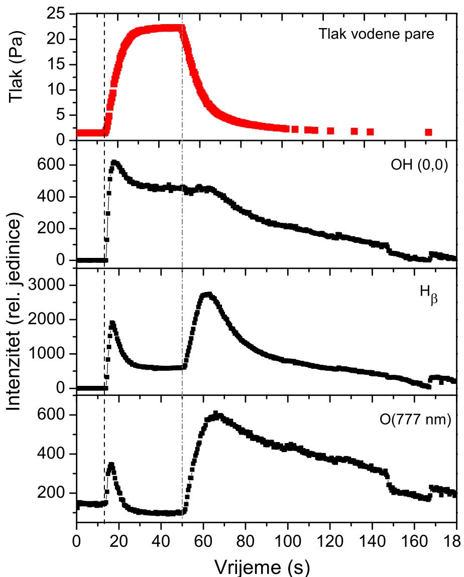
**Slika 5.17:** Vremenski razlučeni tlak vodene pare i intenziteti za  $H_\beta$  liniju na 486 nm, O ( $3d^5D - 3p^5P$ ) liniju na 926.3 nm i OH( $0,0$ ) vrpcu na 309 nm. Crtkane linije označavaju otvaranje i zatvaranje ventila.
