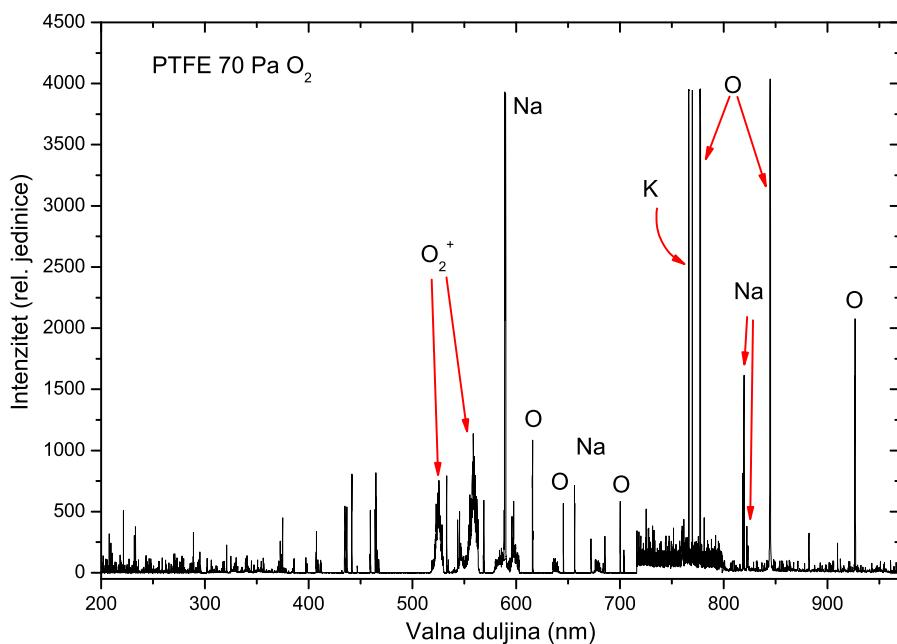
**Slika 5.77:** Spektar plazme kisika, s oštećenim borosilikatnim stakлом u komori.
