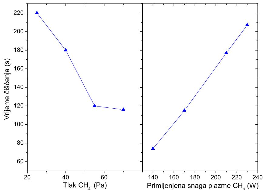
**Slika 5.26:** Karakteristično vrijeme u kojem se transmisija vraća na 100 % prilikom uklanjanja slojeva  $\text{O}_2$  plazmom. Lijevi graf prikazuje to vrijeme pri promjeni tlaka, a desni pri promjeni snage.
