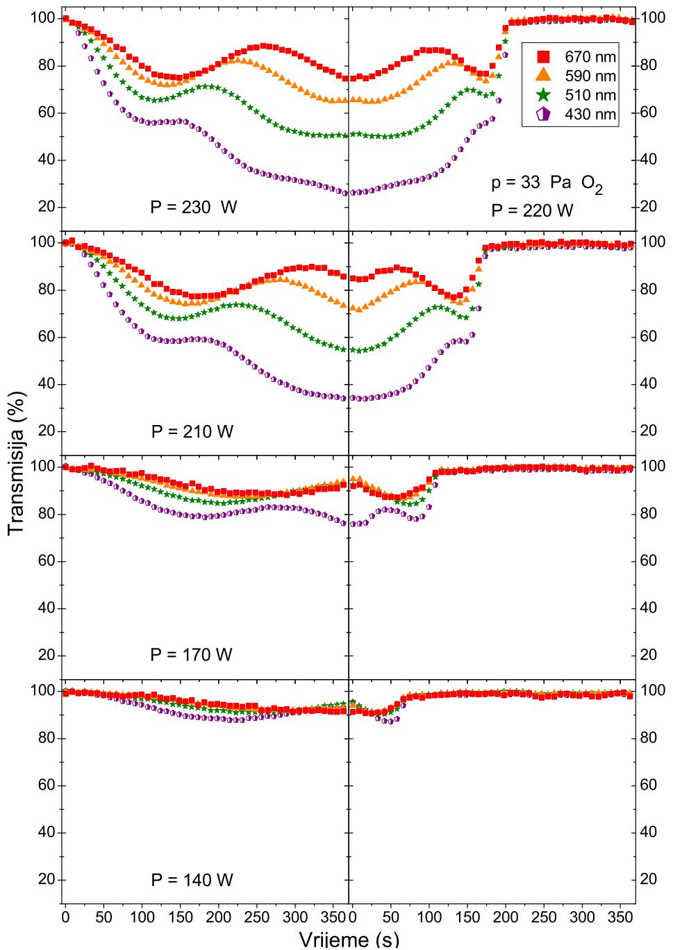
**Slika 5.25:** Transmisija svjetla u vremenu kroz napareni sloj, za četiri različite snage. Lijevi stupac prikazuje transmisiju prilikom naparavanja za 140-230 W uz tlak od 25 Pa CH<sub>4</sub>. Desni stupac prikazuje transmisiju prilikom uklanjanja slojeva, tlak O<sub>2</sub> je uvijek 33 Pa, a snaga 220W.
