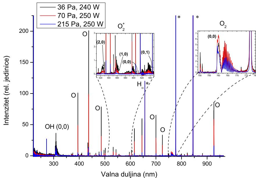
**Slika 5.1:** Optički emisijski spektar kisika, za tri različita tlaka, uvećani su dijelovi spektra s molekulskim vrpcama. Primjenjena snaga je 240-250 W.
