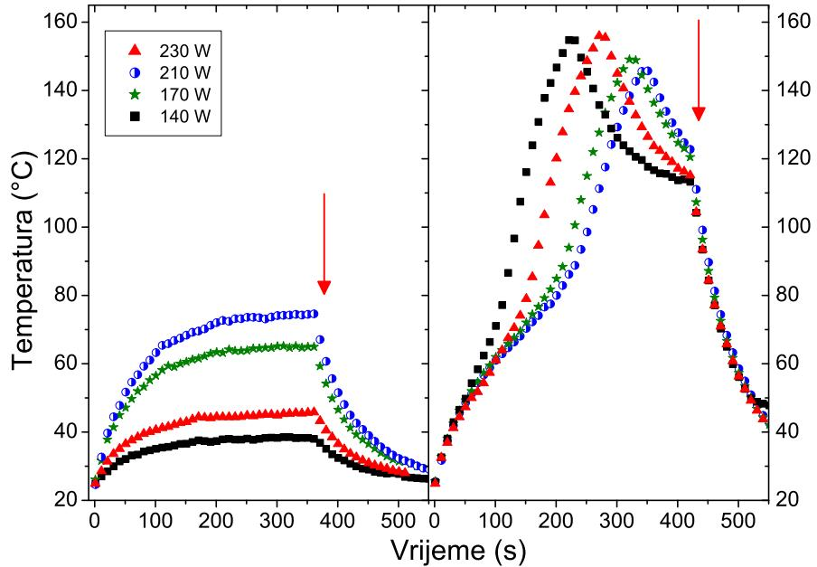
**Slika 5.27:** Temperatura cijevi prilikom procesa naparavanja u  $CH_4$  plazmi (lijevo) i uklanjanja slojeva  $O_2$  plazmom (desno). Naparavanje je uvijek bilo s 25 Pa  $CH_4$ , a uklanjanje s 33 Pa  $O_2$  i 220 W. Crvene strelice označavaju isključivanje plazme.
