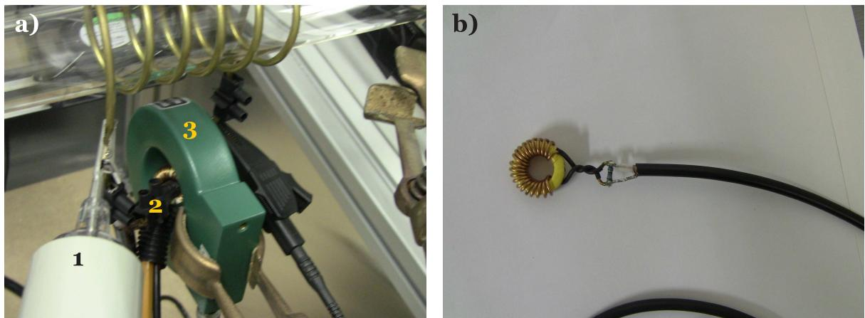
**Slika 4.13:** a) električne sonde uklopljene u sistem (1 - Tektronix P6015A, 2 - sonda domaće izrade, 3 - Pearson 6595) b) fotografija domaće sonde za mjerjenje struje.
