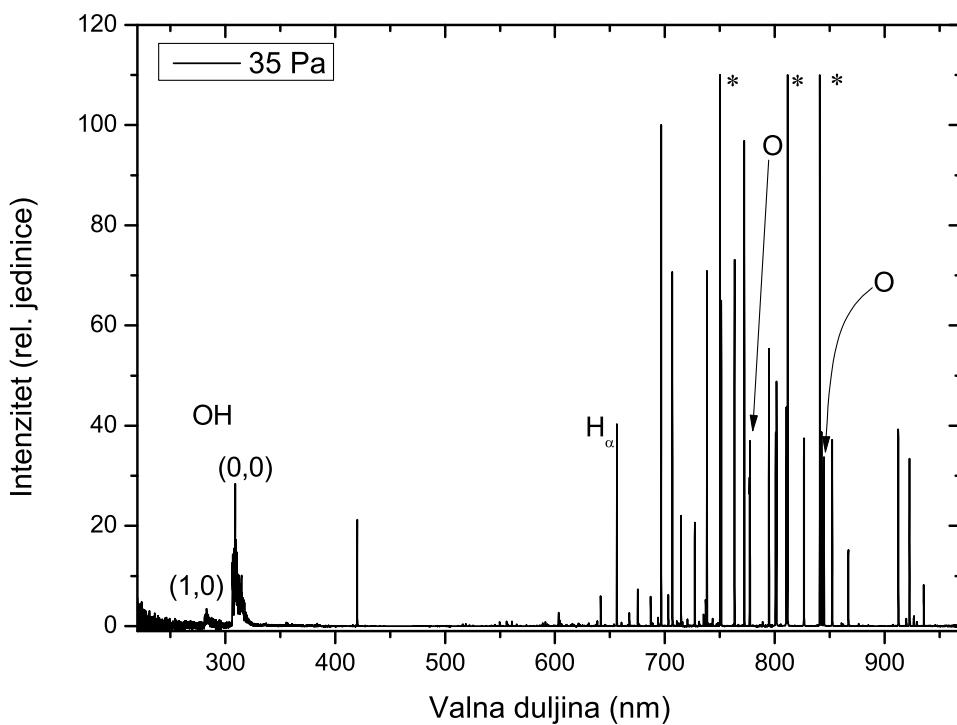
**Slika 5.9:** Optički emisijski spektar argona pri 35 Pa, neke linije argona (700-850 nm) su puštene u saturaciju da bi se bolje vidjele i ostale linije. Linije u saturaciji su označene s (\*), a sve neoznačene linije su linije Ar. Primijenjena snaga je 240 W.
