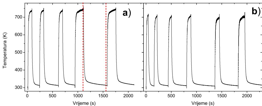
**Slika 5.33:** Temperatura Ni sonde u ovisnosti o vremenu na tlaku od 29 Pa i snazi od 250 W: a) čisti kisik b) mješavina kisika i argona. Crvenim crtama je označeno jedno područje hlađenja sonde, gdje se mjeri  $dT/dt$ , iz koje se računa koncentracija.
