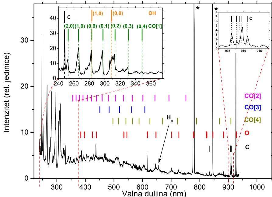
**Slika 5.58:** Tipični kalibrirani spektar kisikove plazme pri tretmanu grafita. Spektar je snimljen 30 s nakon uključenja plazme. Linije u saturaciji su označene sa (\*). Umetci pokazuju detalje 3. pozitivne vrpce CO u UV području, kao i ugljikove linije u IC području. Korištene su kratice: CO[1] = 3. pozitivna vrpca, CO[2] = Triplet, CO[3] = Ångstrom i CO[4] = Asundi.
