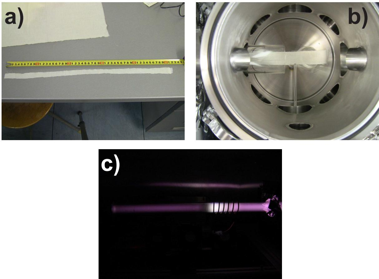
**Slika 5.79:** a) Neobrađeni uzorak sirovog pamuka, b) uzorak unutar komore, primjećuje se i kvarcni štapić za mjerjenje spektra tik iznad uzorka, c) fotografija O<sub>2</sub> - Ar plazme.
