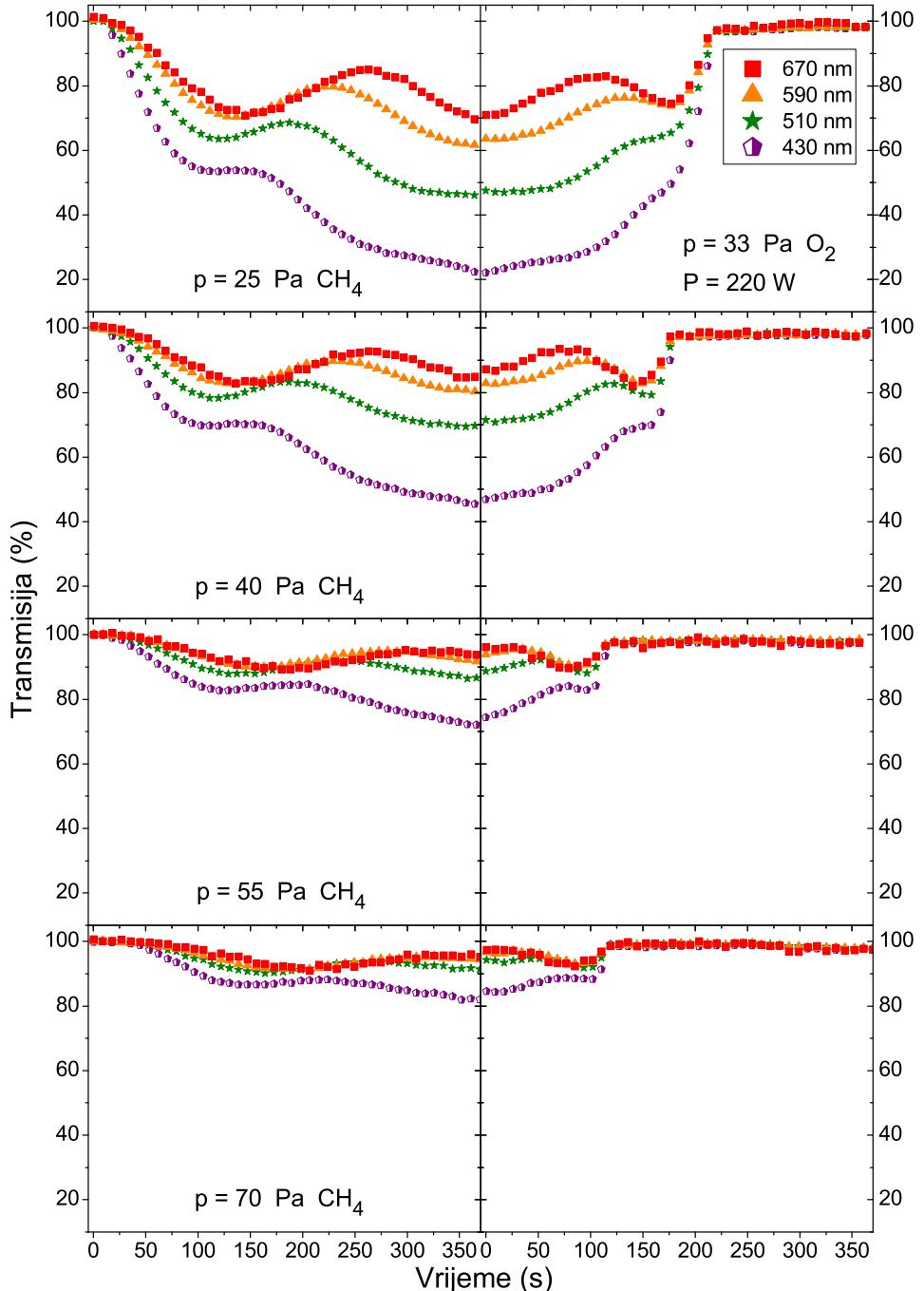
**Slika 5.24:** Transmisija svjetla u vremenu kroz napareni sloj, za četiri različita tlaka  $\text{CH}_4$ . Lijevi stupac prikazuju transmisiju prilikom naparavanja za 25-70 Pa uz 230 W snage. Desni stupac prikazuju transmisiju prilikom uklanjanja slojeva, tlak  $\text{O}_2$  je uvijek 33 Pa, a snaga 220W.
