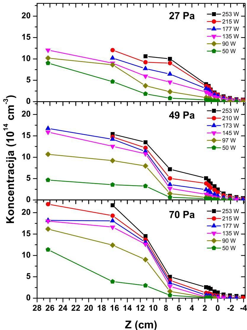
**Slika 5.35:** Prostorna raspodjela koncentracije, za različite primjenjene snage, pri tri različita tlaka kisika. Mjereno u smjeru cijevi.
