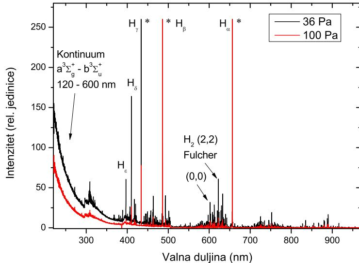
**Slika 5.4:** Optički emisijski spektar vodika, pri tlaku od 36 i 100 Pa, uz primjenjenu snagu od 250 W.
