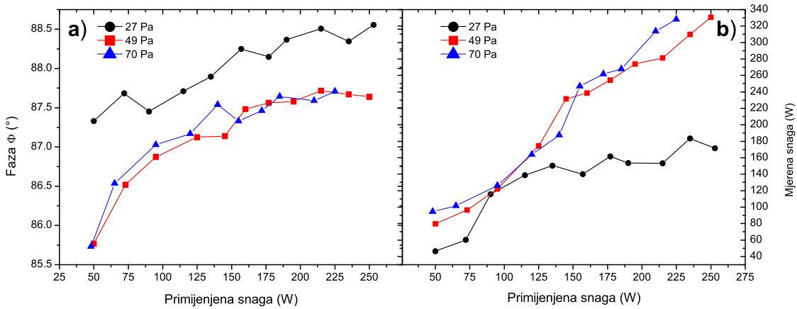
Slika 4.15: a) Faza između struje i napona b) mjerena snaga za različite tlakove u ovisnosti o primjenjenoj snazi.
