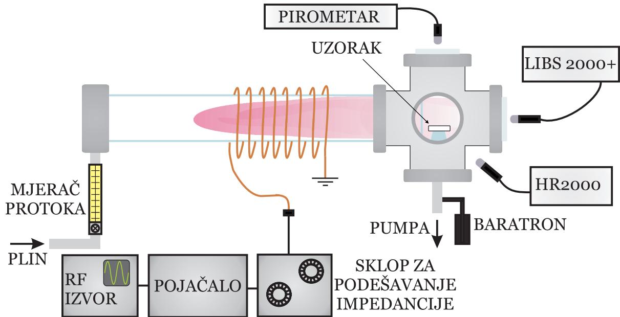
**Slika 4.6:** Eksperimentalni postav s vakuumskom komorom za uzorke
