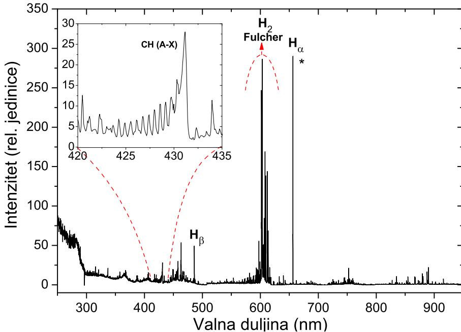
**Slika 5.20:** Spektar  $\text{CH}_4$  plazme, tlak plina je 70 Pa, primjenjena snaga je 230 W.  $\text{H}_\alpha$  linija je u saturaciji, a povećan je dio grafa koji prikazuje  $\text{CH}$  ( $\text{A}^2\Delta \rightarrow \text{X}^2\Pi(0,0)$ ) molekulsку vrpcu.
