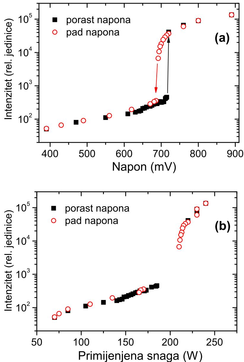
Slika 5.19: Intenzitet H<sub>β</sub> linije na fiksnom tlaku od 10 Pa pri promjeni (a) napona (b) primjenjene snage (položaj z=15 cm).
