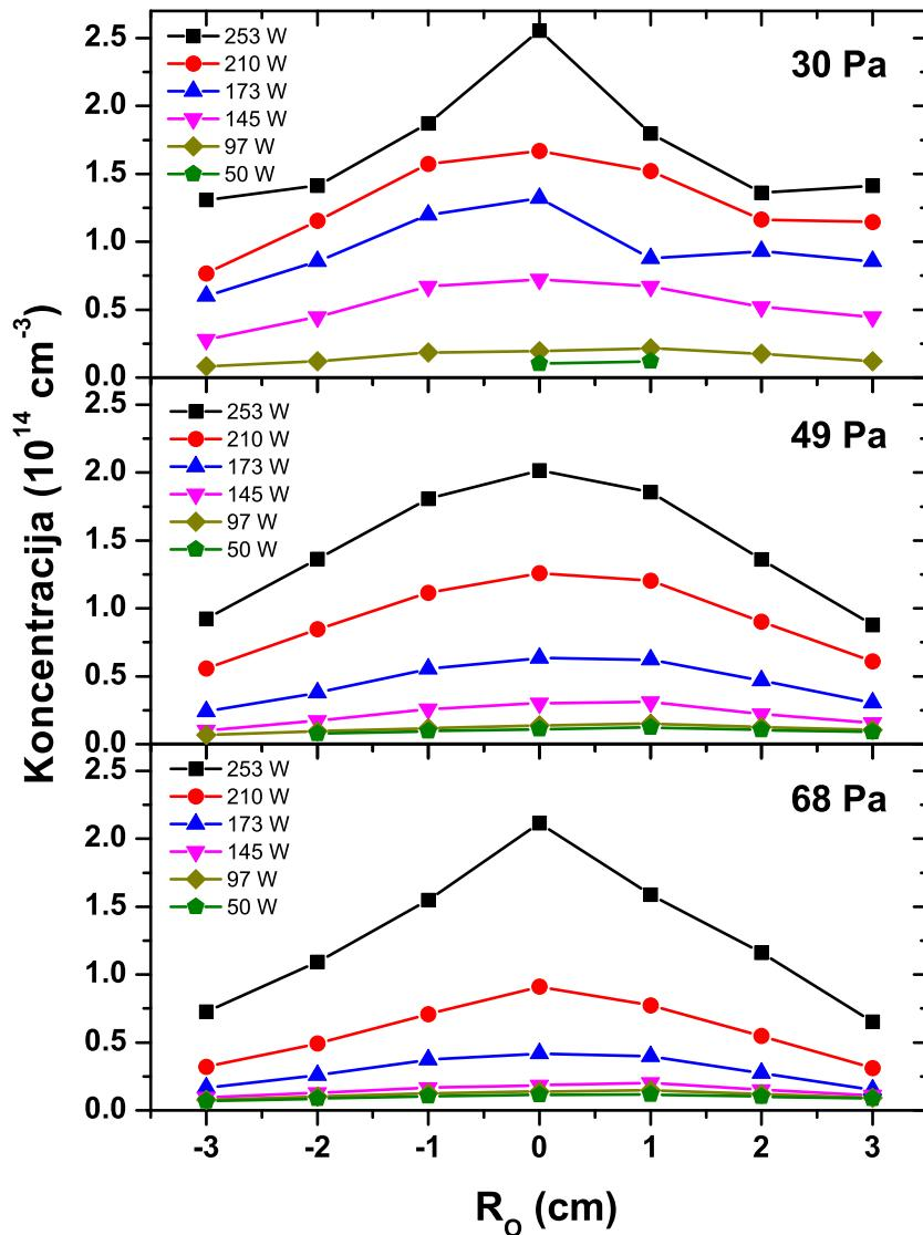
**Slika 5.37:** Prostorna raspodjela koncentracije, za različite primjenjene snage, pri tri različita tlaka kisika. Mjereno okomito na cijev, unutar komore.
