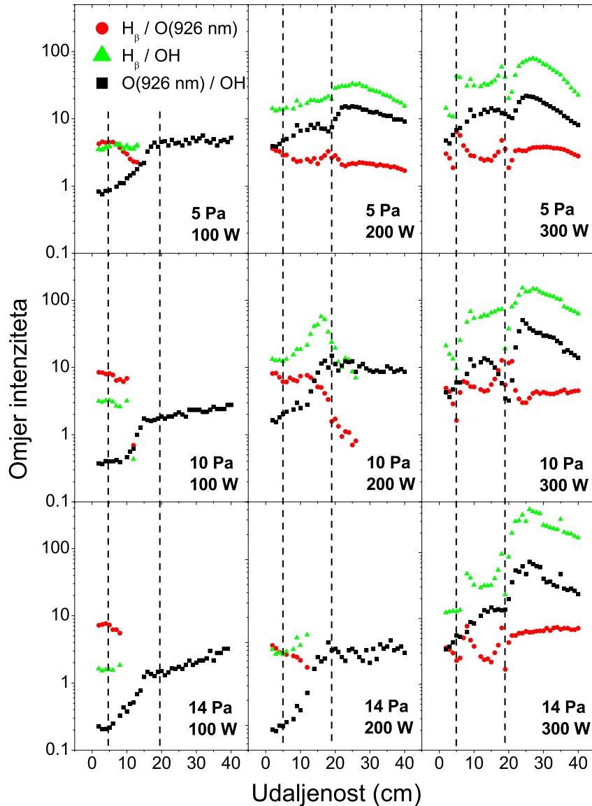
**Slika 5.16:** Prostorna raspodjela omjera intenziteta za  $H_\beta$  na 486 nm, O ( $3d^5D^O - 3p^5P$ ) liniju na 926.3 nm i OH( $0,0$ ) na 309 nm. Tok vodene pare je slijeva nadesno, a crtkane linije označavaju poziciju zavojnice.
