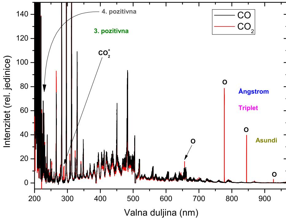
**Slika 5.11:** Optički emisijski spektar CO i  $\text{CO}_2$  plazme, s (\*) su označene vrpce u saturaciji. Tlak CO i  $\text{CO}_2$  plazme je 35 Pa, a snaga 250 W.
