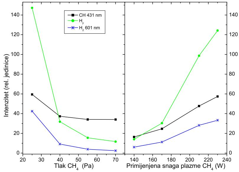
Slika 5.22: Ovisnost intenziteta molekulske vrpce CH (A-X), atomske linije  $H_\beta$  i Q1 linije iz (0,0) Fulcherove vrpce (na 602 nm) o tlaku (fiksna snaga od 230 W) (a) i primjenjenoj snazi (fiksni tlak od 25 Pa) (b).
