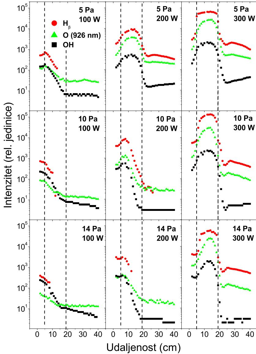
**Slika 5.15:** Prostorna raspodjela intenziteta za  $H_{\beta}$  na 486 nm, O ( $3d^5 D^O - 3p^5 P$ ) liniju na 926.3 nm i OH(0,0) na 309 nm. Tok vodene pare je slijeva nadesno, a crtkane linije označavaju poziciju zavojnice.
