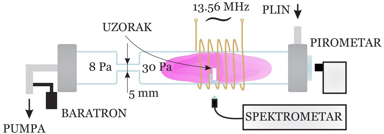
**Slika 5.62:** Shema kvarcne cijevi korištene u eksperimentu.
