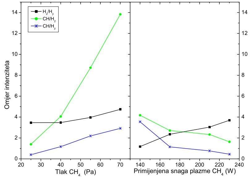
Slika 5.23: Ovisnost omjera intenziteta molekulske vrpce CH (A-X, atomske linije  $H_\beta$  i Q1 linije iz (0,0) Fulcherove vrpce (na 602 nm) o tlaku (fiksna snaga od 230 W) (a) i primjenjenoj snazi (fiksni tlak od 25 Pa) (b).
