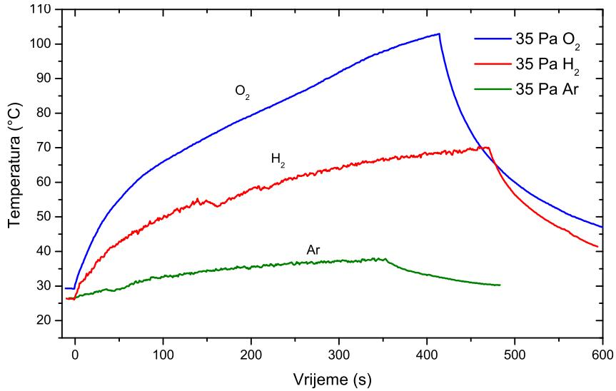
Slika 5.67: Temperatura uzoraka u vremenu, za tri plina.
