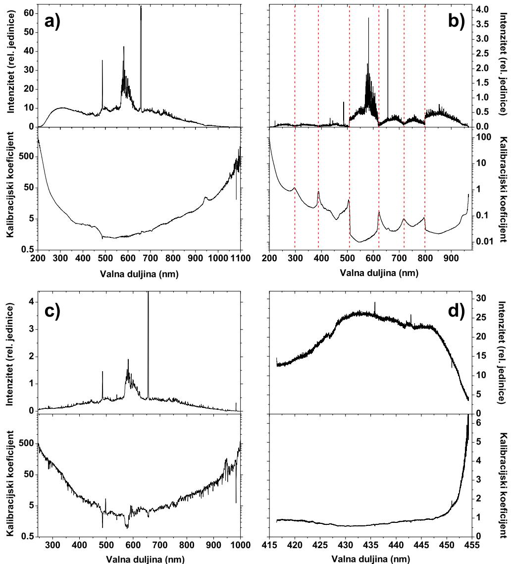
**Slika 4.11:** Snimljeni spektar kalibracijske lampe i kalibracijska krivulja za spektrometre:
