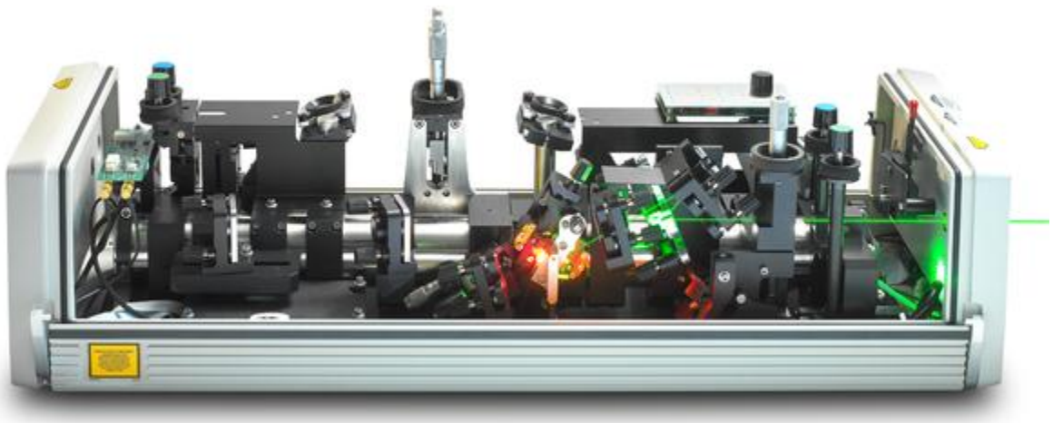
Slika 21: Unutrašnjost Tsunami lasera i preuzeta je iz [36]. Vidi se ulazni zeleni snop s desne strane (tipično 532 nm).
