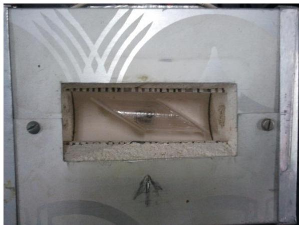
**Slika 44:** Prikazuje kivetu punjenu mješavinom rubidija i cezija položenu u peč. U slučaju K-Rb i Rb-Cs kivete radi se o safirnoj kiveti s mogućnošću grijanja na visoke temperature (preko 500°C), dok se u slučaju čistog kalija radi o kvarcnoj kiveti (s mogućnošću grijanja na temperature do 100°C). Uočavamo kose prozore kivete, zbog smanjenja utjecaja refleksija (*Brewsterovi* prozori).
