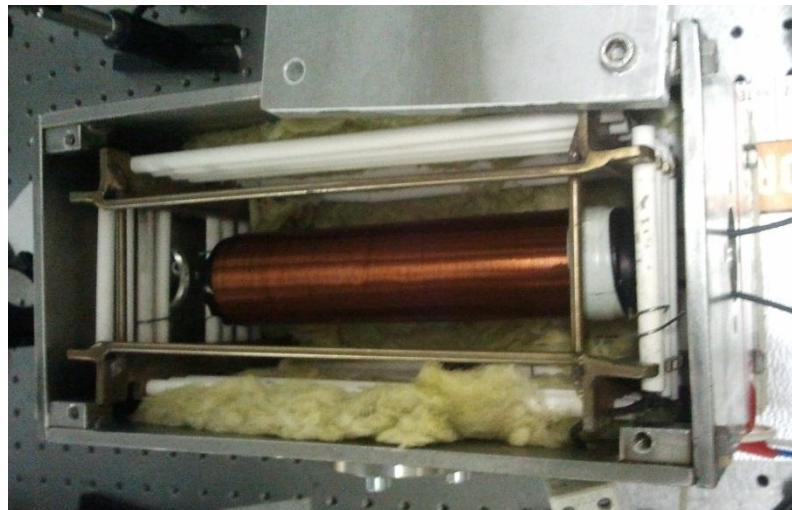
**Slika 32:** Unutrašnjost peći. Uočavamo zavojnicu, unutar nje se nalazi naša kiveta punjena kalijem. Oko peći se vidi kamena vuna za bolju stabilizaciju temperature prilikom mjerena.
