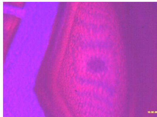
Slika 5.4.6. Optičke slike «otočnih» struktura uzorka SOI7 snimljene optičkim mikroskopom s plavim filtrom kod povećanja objektiva 100 i 500 puta.
