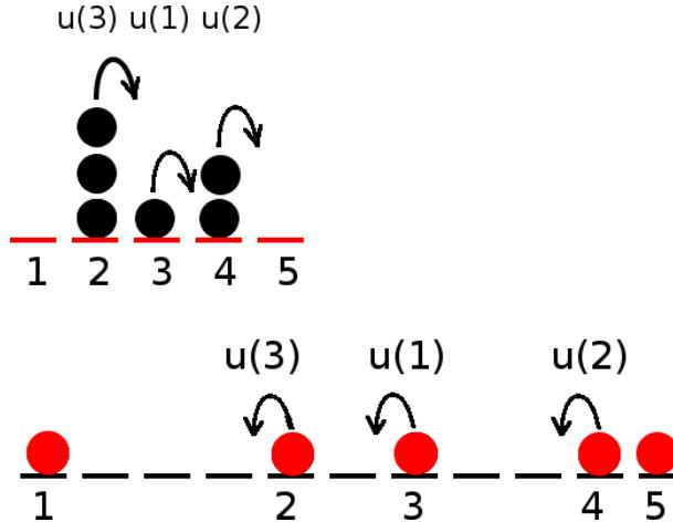
Slika 2.5: Preslikavanje ZRP-a na TASEP. Čvorovi u ZRP-u (označeni brojevima) preslikavaju se u čestice u TASEP-u, a broj čestica na nekom čvoru  $i = 1, \dots, L$  u ZRP-u odgovara broju čestica u TASEP-u ispred  $i$ -te čestice.
