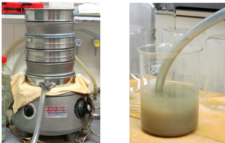
Slika 9: Set Retsch® ASTM sita, Geološko-paleontološki zavod PMF-a.
