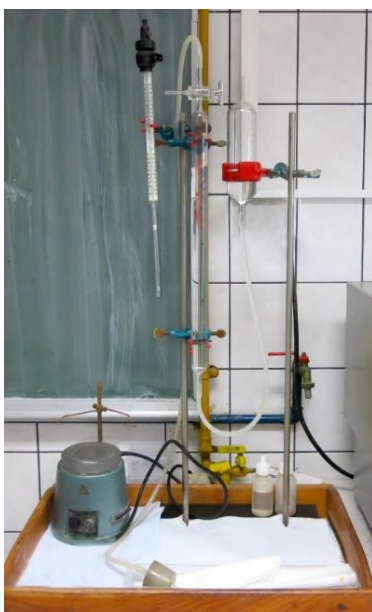
Slika 11: Scheiblerova aparatura za kalcimetriju, Mineraloško-petrografski zavod PMF-a.
