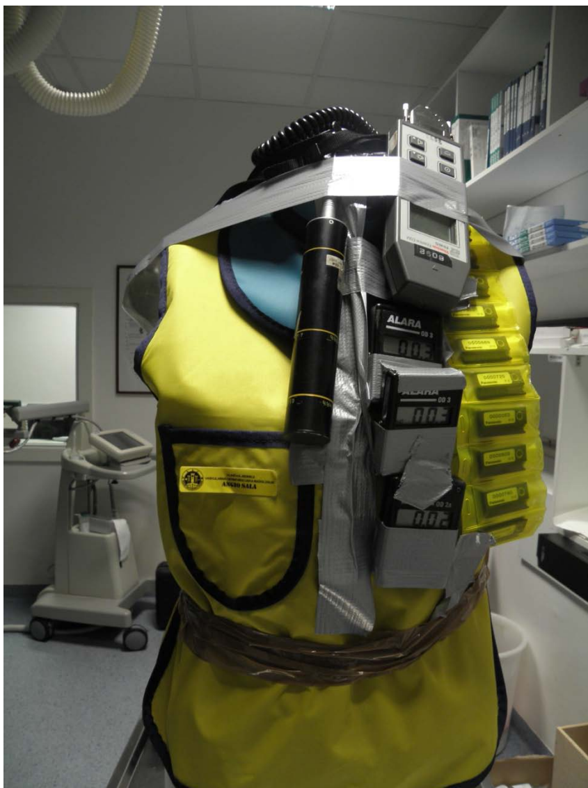
Slika 3.13. Postav mjernih instrumenata na zaštitnoj olovnoj pregači fantoma - intervencijskog radiologa. Iako su postavljena 3 AEPD-a za potrebe ovog rada korišteni su mjerni rezultati samo središnjeg AEPD-a i TLD-a u njegovoj ravnini.
