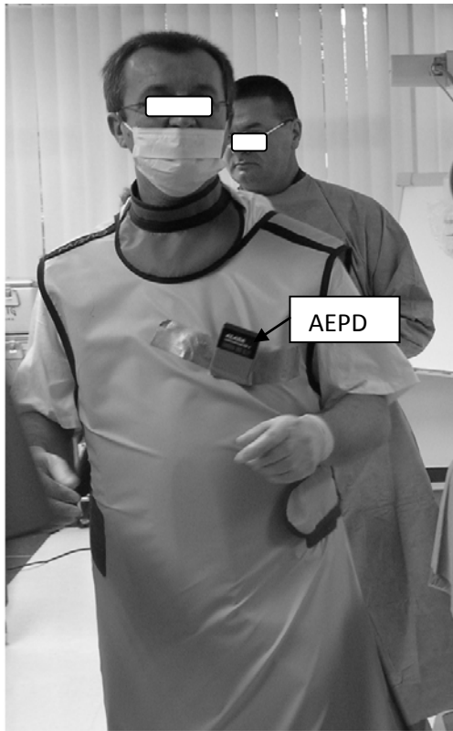
Slika 4.9. Položaj AEPD-a s vanjske strane zaštitne olovne pregače
