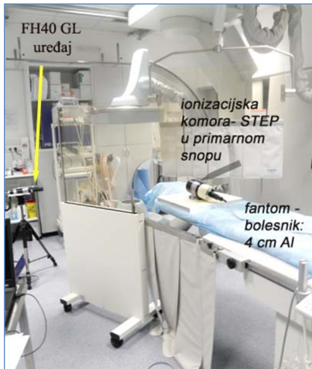
Slika 9.1. Al debljine 4 cm – rendgenskom uređaju pripadajući originalni fantom trupa bolesnika – sekundarni izvor raspršenog zračenja STEP ionizacijska komora volumena 1 l – priznati instrument za mjerenja u pulsним poljima i FH 40GL mjerne sonde.
