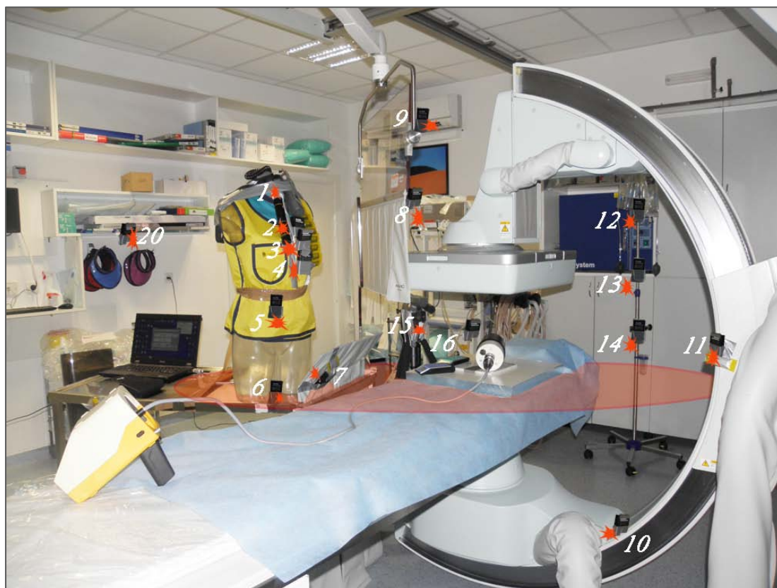
Slika 11.7. Skica mjernih pozicija AED ALARA OD 3 u IR dvorani za 17 IR postupaka navedenih od 1 do 17 u tablici 11.1. AED-i su bili uvijek na istim pozicijama u IR dvorani, u ravnini xy na visini 0,9 m od poda i na raznim pozicijama i visinama. Pozicije AED-a skicirane su zvjezdasto crveno. Za vrijeme mjerenja nisu svi AED-i bili na jednakim udaljenostima od točke O(0,0,0) . Maneken – fantom liječnika opremljen je mjernim instrumentima i zaštitnom pregačom prema pravilima struke.
