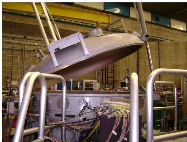
Slika 4.1: Komora za mjerenje nuklearnih reakcija CT2000.
