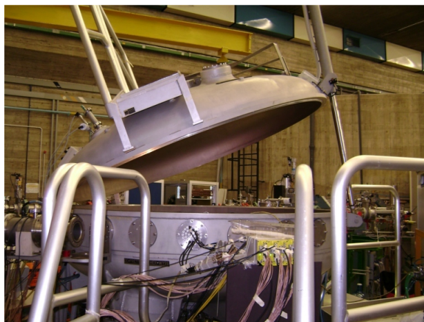
Slika 4.1: Komora za mjerenje nuklearnih reakcija CT2000.
