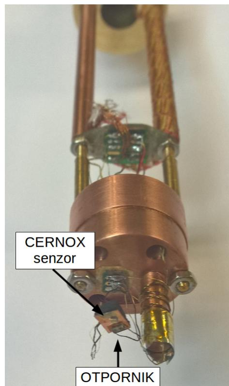
Slika 4.5: Proba prilagođena za AC kalorimetrijsko mjerjenje.
