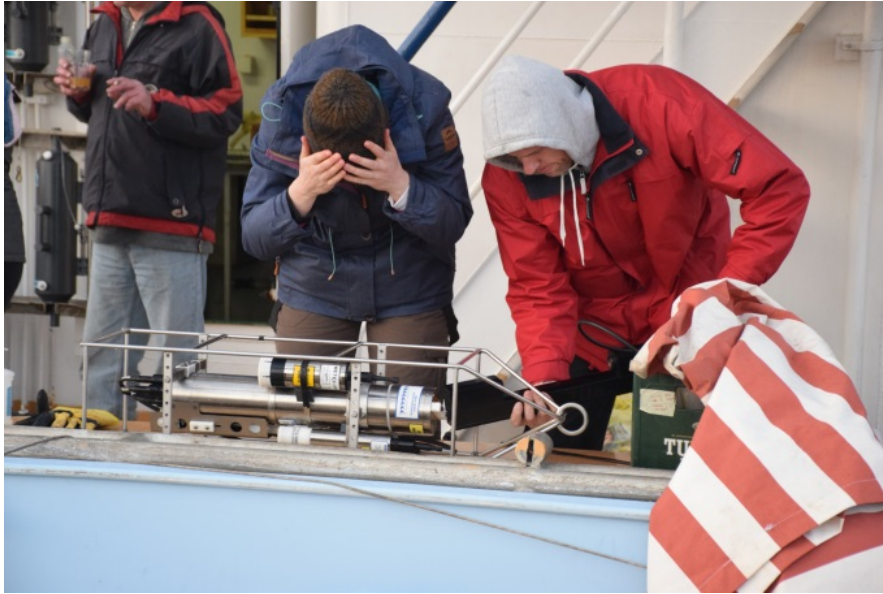
Slika 8. Bio-optički senzor za mjerenje atenuacije – transmisiometar C-Star
