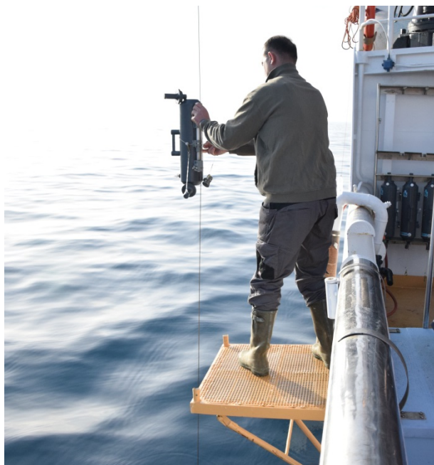
Slika 12. Niskinov crpac- uređaj za uzimanje uzoraka vode
