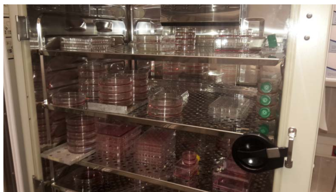
Slika 3. Prikaz inkubatora gdje su stanice održavane na 37 °C s 5% CO 2 i 95% zrakom
