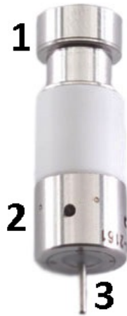
Slika 4.5: Detektor korišten u eksperimentu [12]. Dio označen sa 1. zovemo baza; 2. je kolektor; 3. je pin
