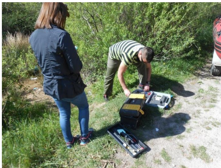
Slika 7 Mjerenje fizikalno-kemijskih čimbenika kakvoće vode pomoću sonde SevenGo (Mettler Toledo) (snimila Vlatka Filipović Marijić).
