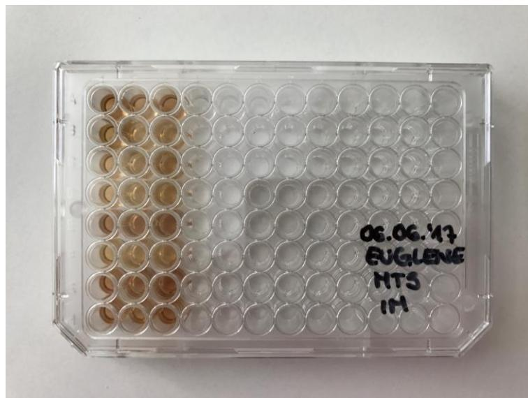
**Slika 17.** Pločica s 96 bunarića nakon inkubacije uzorka s reagensom
