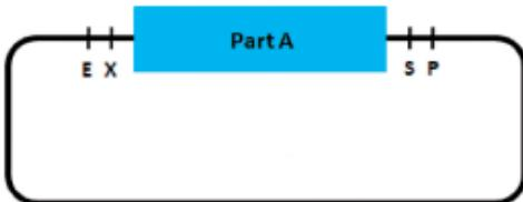
**Slika 4.** Primjer *BioBrick*-a na plazmidu. Određeni genetički element „Part A“ omeđen je specifičnim restriktivskim mjestima (Preuzeto iz Sleight i sur. 2010)
