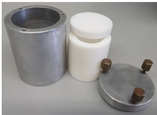
Slika 22. Autoklav za solvotermalnu sintezu.
