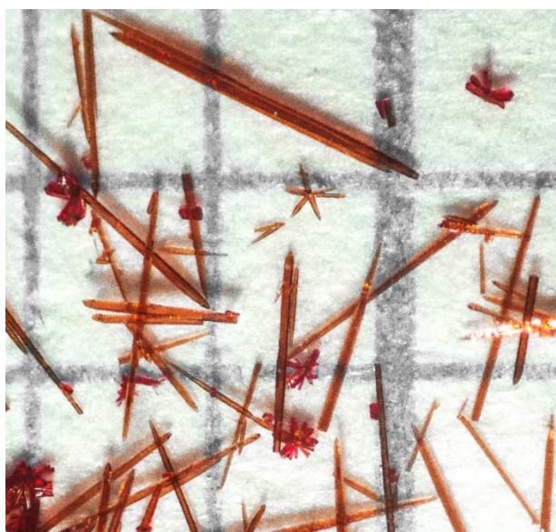
Slika 26. Mikrofotografija transformacije jediničnih kristala spoja [\text{Co}(\text{NH}_3)_6][\text{Fe}(\text{C}_2\text{O}_4)_3] u kristale spoja [\text{CoC}_2\text{O}_4(\text{NH}_3)_4][\text{Fe}(\text{C}_2\text{O}_4)_2(\text{OH}_2)_2] \cdot 2\text{H}_2\text{O} . a) stanje nakon jednog dana starenja u matičnici (stranica kvadratića predstavlja duljinu 1 mm) b) stanje nakon dva dana starenja u matičnici (10x uvećanje).
