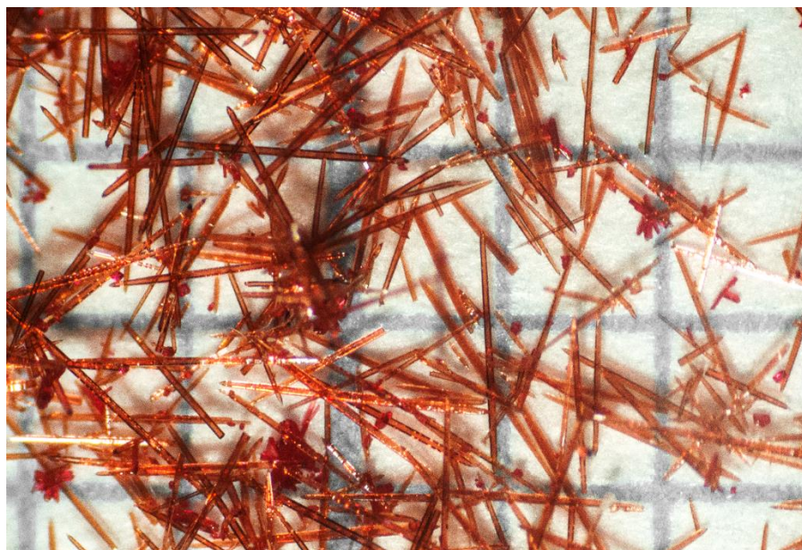
Slika 25. Mikrofotografija jediničnih kristala spoja [\text{Co}(\text{NH}_3)_6][\text{Fe}(\text{C}_2\text{O}_4)_3] , prizmatske morfologije i igličastog habitusa (stranica kvadratića predstavlja duljinu 1 mm).
