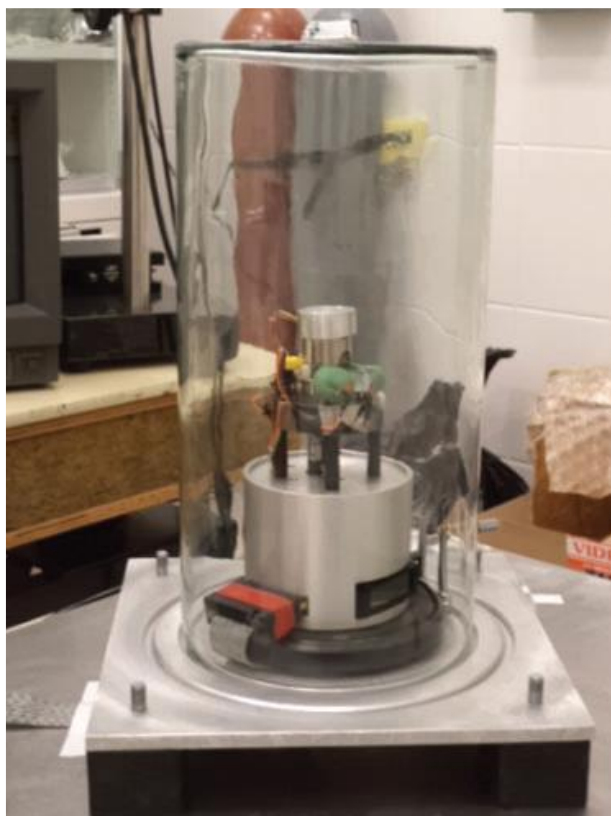
Slika 11. EC-STM smješten pod stakleno zvono ispunjeno dušikom kako bi se osigurali anoksični uvjeti
