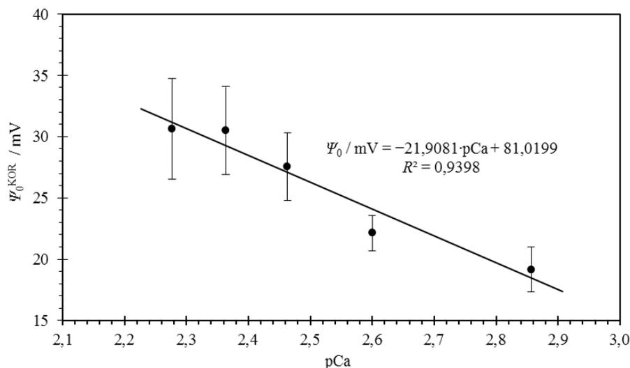
Slika 4.32. Ovisnost površinskog potencijala (111) plohe fluorita, korigiranog za utjecaj ionske jakosti, o negativnom logaritmu relativnog aktiviteta  $\text{Ca}^{2+}$  iona u otopini NaCl ( $1 \times 10^{-3} \text{ mol dm}^{-3}$ ) pri  $\text{pH} = 5,0 \pm 0,1$  i  $25 \text{ }^\circ\text{C}$  (podaci sa slike 4.13.). Prikazani pravac je dobiven linearnom regresijskom analizom.
