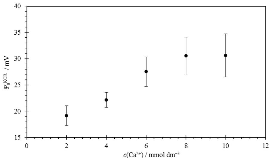
Slika 4.13. Ovisnost površinskog potencijala (111) plohe fluorita, korigiranog za utjecaj ionske jakosti, o koncentraciji  $\text{Ca}^{2+}$  iona u otopini  $\text{NaCl}$  ( $1 \times 10^{-3}$  mol dm<sup>-3</sup>). Titracija je provedena otopinom  $\text{CaCl}_2$  u atmosferi argona pri  $\text{pH} = 5,0 \pm 0,1$  i  $25$  °C. Standardna odstupanja odgovaraju korijenu sume varijanci od podataka prikazanih na slici 4.9. i slici 4.12.
