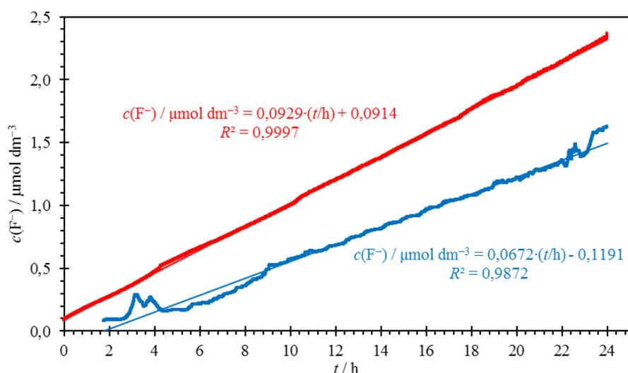
Slika 4.25. Vremenska ovisnost koncentracije  $F^-$  iona tijekom otapanja (111) plohe fluorita određena uz miješanje reakcijske smjese brzinom od približno 600 okretaja u minuti (crvene točke) i bez miješanja reakcijske smjese (plave točke) u atmosferi argona pri  $25\text{ }^\circ\text{C}$ ,  $\text{pH} = 5,0 \pm 0,3$  i  $I_c \approx 1 \times 10^{-3} \text{ mol dm}^{-3}$  koja je održavana stalnom pomoću NaCl.
