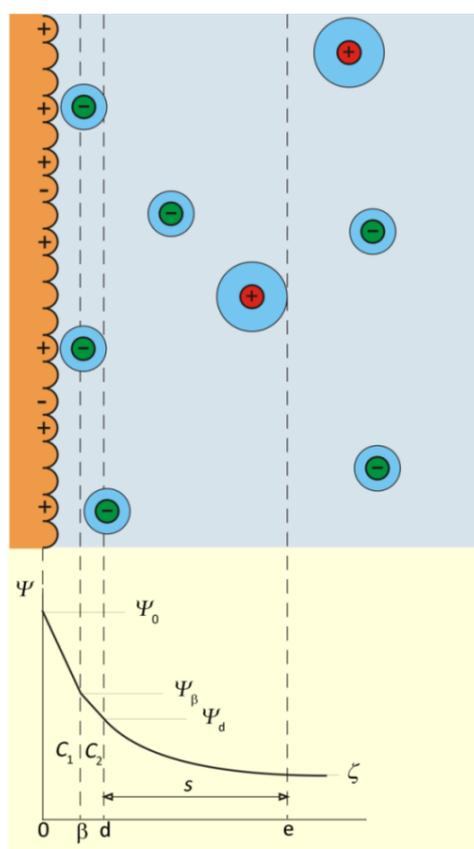
Slika 2.4. Opći model električnog međupovršinskog sloja.<sup>5</sup>
