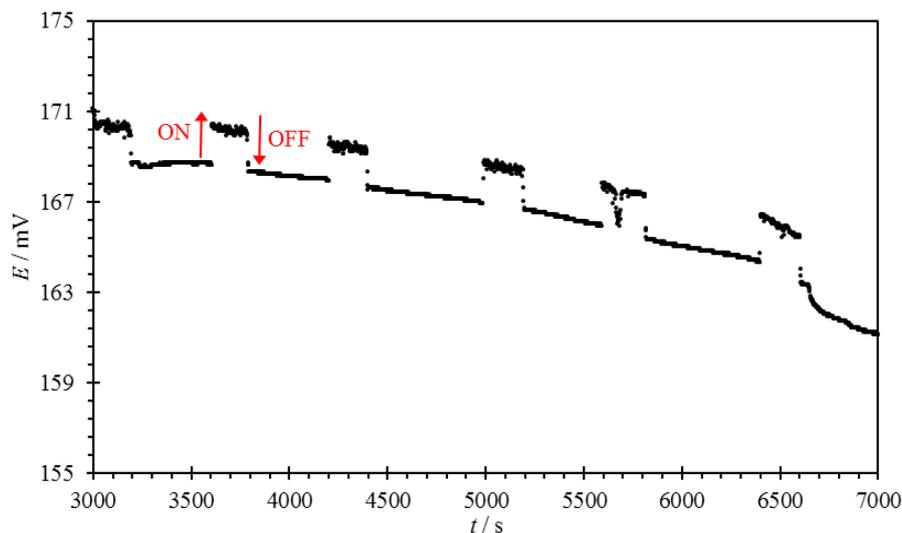
Slika 4.3. Izdvojeni dio vremenske ovisnosti elektromotivnosti članka sastavljenog od fluoritne SCrE i kombinirane elektrode tijekom titracije otopine HCl otopinom NaOH u pH području od 4,9 do 9,6.
