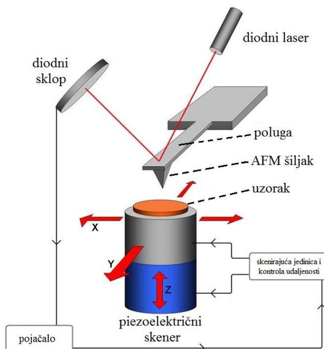
Slika 2.11. Princip rada mikroskopa atomskih sila (AFM-a).<sup>63</sup>
