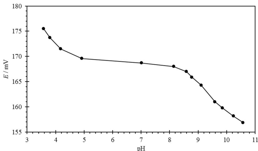
Slika 4.5. Ovisnost elektromotivnosti članka sastavljenog od fluoritne S<sub>CrE</sub> i kombinirane elektrode o pH. Titracija otopine HCl otopinom NaOH je provedena u atmosferi argona pri 25 °C i ionskoj jakosti od  $1 \times 10^{-3}$  mol dm<sup>-3</sup> koja je održavana stalnom pomoću NaCl. Linija je provučena kroz točke kako bi se lakše pratio trend.
