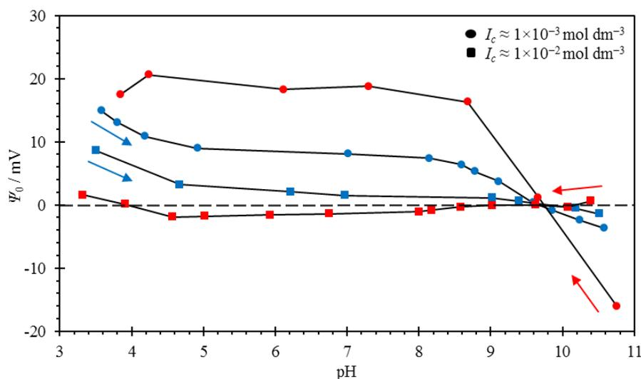
Slika 4.6. Ovisnost površinskog potencijala (111) plohe fluorita o pH za acidimetrijsku (crvene točke i crvene strelice) i alkalimetrijsku (plave točke i plave strelice) titraciju. Mjerenja su provedena u atmosferi argona pri 25 °C i ionskim jakostima naznačenim na legendi. Ionske jakosti su održavane stalnim pomoću NaCl. Linije su provučene kroz točke kako bi se lakše pratilo trend.
