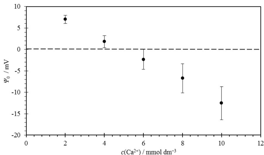
Slika 4.12. Ovisnost površinskog potencijala (111) plohe fluorita o koncentraciji  $\text{Ca}^{2+}$  iona u otopini  $\text{NaCl}$  ( $1 \times 10^{-3} \text{ mol dm}^{-3}$ ). Titracija je provedena otopinom  $\text{CaCl}_2$  u atmosferi argona pri  $\text{pH} = 5,0 \pm 0,1$  i  $25^\circ \text{C}$ . Standardna odstupanja odgovaraju trima istovjetnim, ali nezavisnim mjerenjima.
