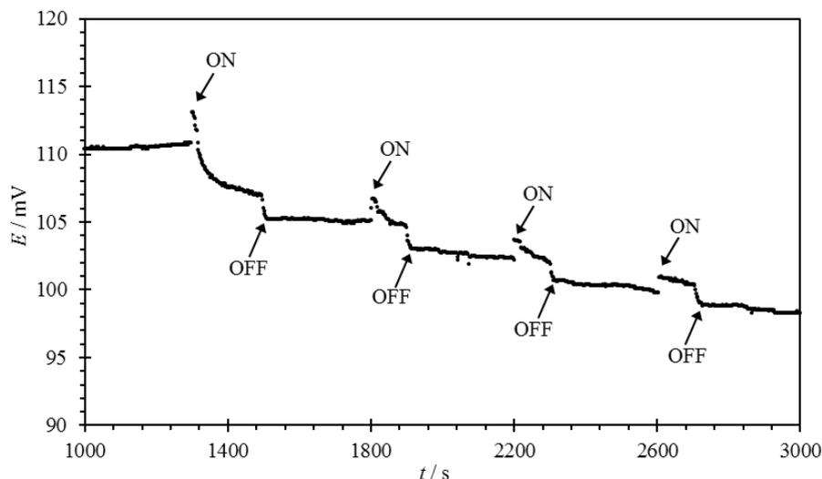
Slika 4.14. Izdvojeni dio vremenske ovisnosti elektromotivnosti članka sastavljenog od fluoritne S<sub>Cr</sub>E i kombinirane elektrode tijekom titracije otopine NaCl ( $1 \times 10^{-3}$  mol dm<sup>-3</sup>) s otopinom NaF. Titracija je provedena u atmosferi argona pri pH =  $5,0 \pm 0,1$  i 25 °C. Oznaka ON i OFF predstavlja trenutak kada je uključena odnosno isključena magnetska miješalica. U tom periodu je dodan titrans.
