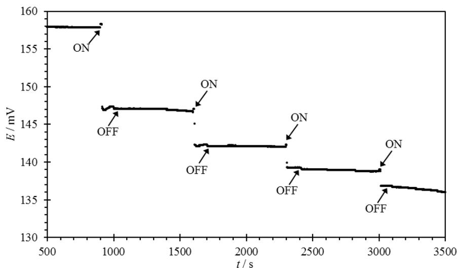
Slika 4.10. Izdvojeni dio vremenske ovisnosti elektromotivnosti članka sastavljenog od fluoritne SCrE i kombinirane elektrode tijekom titracije otopine  $\text{NaCl}$  ( $1 \times 10^{-3} \text{ mol dm}^{-3}$ ) s otopinom  $\text{CaCl}_2$ . Titracija je provedena u atmosferi argona pri  $\text{pH} = 5,0 \pm 0,1$  i  $25 \text{ }^\circ\text{C}$ . Oznaka ON i OFF predstavlja trenutak kada je uključena odnosno isključena magnetska miješalica. U tom periodu je dodan titrans.
