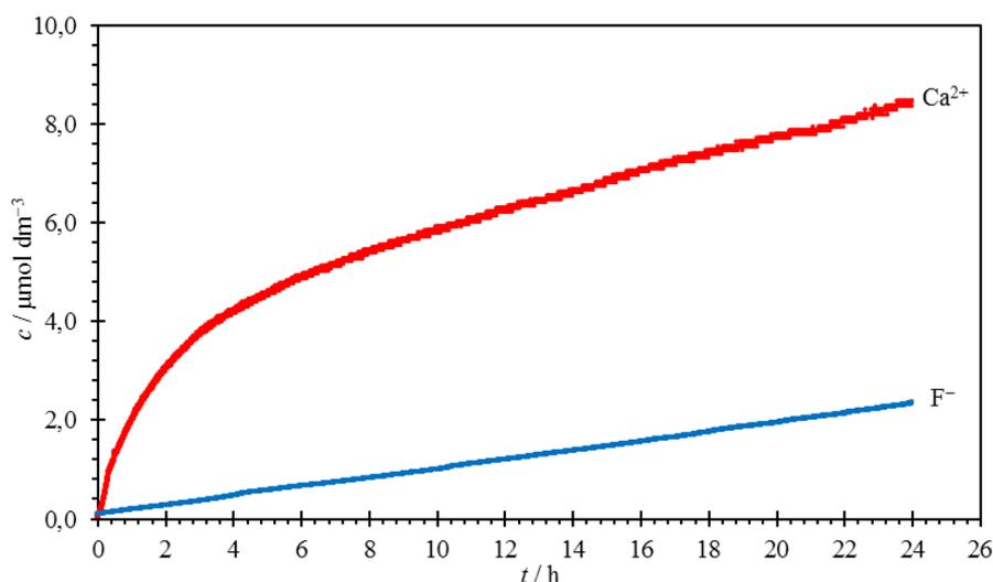
Slika 4.27. Vremenske ovisnosti koncentracije  $\text{Ca}^{2+}$  iona (crvene točke) i  $\text{F}^-$  iona (plave točke) tijekom 24 sata otapanja (111) plohe fluorita određene uz miješanje reakcijske smjese brzinom od približno 600 okretaja u minuti u atmosferi argona pri 25 °C,  $\text{pH} = 5,0 \pm 0,3$  i  $I_c \approx 1 \times 10^{-3} \text{ mol dm}^{-3}$  koja je održavana stalnom pomoću NaCl.
