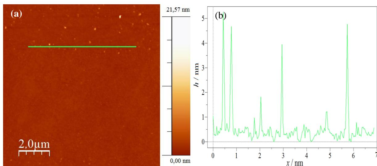
Slika 4.18. (a) AFM prikaz  $10,1 \mu\text{m} \times 10,1 \mu\text{m}$  površine (111) plohe nekorištenog monokristala fluorita snimljen u ambijentalnim uvjetima te (b) visinski profil naznačen na AFM prikazu pod (a) zelenom linijom.
