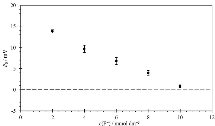
Slika 4.16. Ovisnost površinskog potencijala (111) plohe fluorita o koncentraciji  $\text{F}^-$  iona u otopini NaCl ( $1 \times 10^{-3} \text{ mol dm}^{-3}$ ). Titracija je provedena otopinom NaF u atmosferi argona pri  $\text{pH} = 5,0 \pm 0,1$  i  $25 \text{ }^\circ\text{C}$ . Standardna odstupanja odgovaraju trima istovjetnim, ali nezavisnim mjerenjima.
