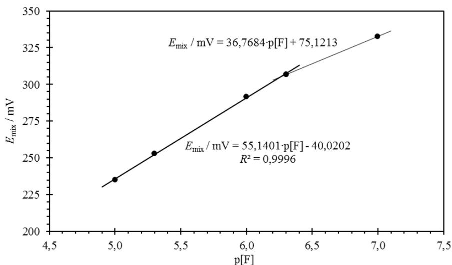
Slika 4.21. Baždarni dijagram fluoridne ISE uz miješanje reakcijske smjese brzinom od približno 600 okretaja u minuti - ovisnost elektromotivnosti članka sačinjenog od fluoridne ISE i kombinirane elektrode o negativnom logaritmu koncentracije  $\text{F}^-$  iona u otopini pri  $25\text{ }^\circ\text{C}$ ,  $\text{pH} = 5,0 \pm 0,1$  i  $I_c \approx 1 \times 10^{-3} \text{ mol dm}^{-3}$  koja je održavana stalnom pomoću NaCl. Baždarni dijagram je napravljen prema podacima iz tablice D1.
