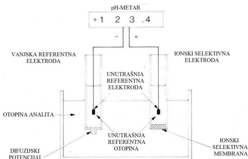
Slika 2.6. Galvanski članak sastavljen od referentne i ionski selektivne elektrode.<sup>52</sup>
