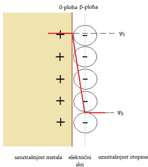
Slika 2.1. Helmholtzov model električnog međupovršinskog sloja.<sup>23</sup>
