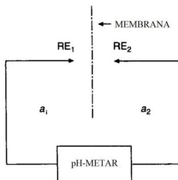
Slika 2.8. Shematski prikaz koncentracijskog članka. RE<sub>1</sub> je vanjska referentna elektroda uronjena u otopinu analita nepoznatog relativnog aktiviteta  $a_i$ , a RE<sub>2</sub> je unutrašnja referentna elektroda uronjena u unutrašnji elektrolit poznatog relativnog aktiviteta iona  $a_2$ .<sup>55</sup>
