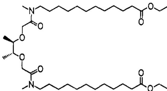
Slika 2.10. Struktura ionskog izmjenjivača poznatog pod imenom ETH 1001 koji se koristi kao element za prepoznavanje u kalcijevim ionski selektivnim elektrodama.<sup>59</sup>
