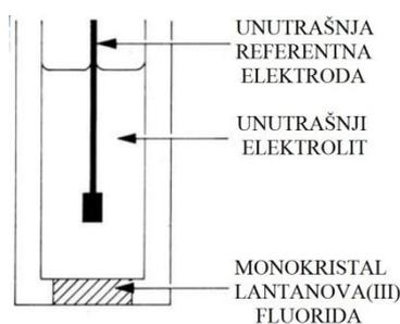
Slika 2.7. Izvedba fluoridne ionski selektivne elektrode.<sup>52</sup>
