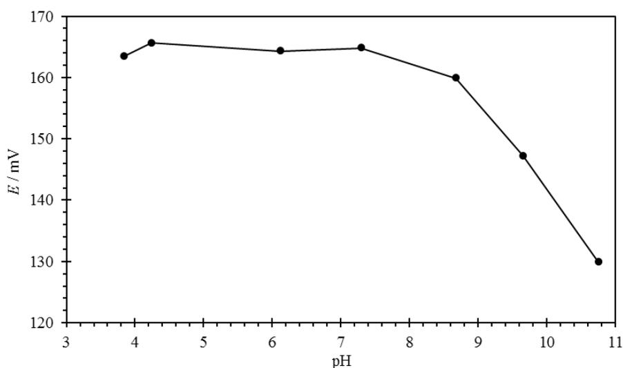
Slika 4.4. Ovisnost elektromotivnosti članka sastavljenog od fluoritne S<sub>CrE</sub> i kombinirane elektrode o pH. Titracija otopine NaOH otopinom HCl je provedena u atmosferi argona pri 25 °C i ionskoj jakosti od  $1 \times 10^{-3} \text{ mol dm}^{-3}$  koja je održavana stalnom pomoću NaCl. Linija je provučena kroz točke kako bi se lakše pratio trend.
