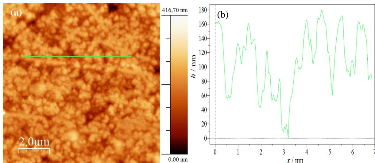
Slika 4.19. (a) AFM prikaz  $10,1 \mu\text{m} \times 10,1 \mu\text{m}$  površine (111) plohe monokristala fluorita korištenog u mjerenjima s fluoritnom SCrE snimljen u ambijentalnim uvjetima te (b) visinski profil naznačen na AFM prikazu pod (a) zelenom linijom.
