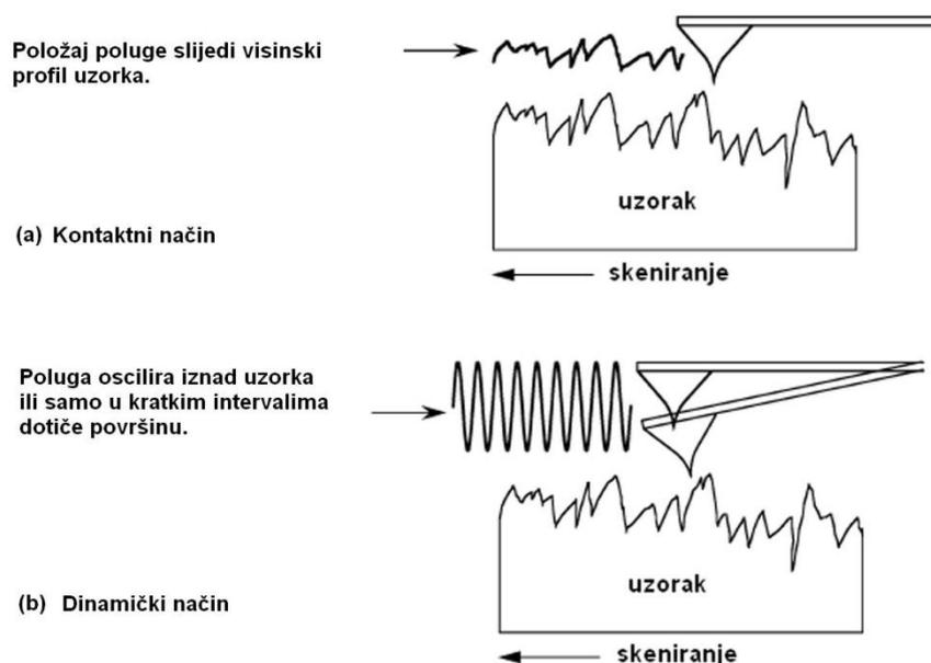
Slika 2.12. (a) Kontaktни i (b) dinamički način rada AFM-a.<sup>62</sup>
