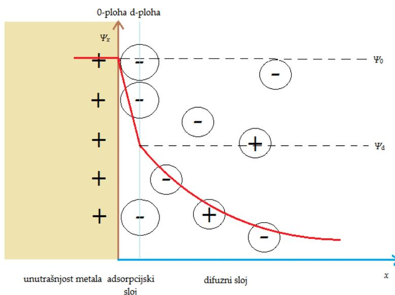
Slika 2.3. Sternov model električnog međupovršinskog sloja.<sup>23</sup>
