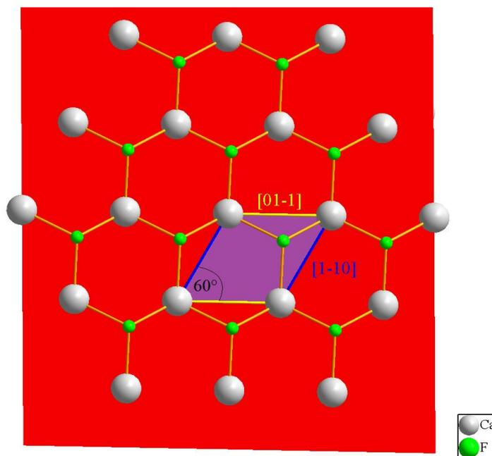
Slika 4.31. Pogled odozgo na crveno označenu (111) plohu fluorita s žuto naznačenim [01-1] smjerom i plavo naznačenim [1-10] smjerom između susjednih  $\text{Ca}^{2+}$  iona. Slika je napravljena prema kristalografskim podacima<sup>1</sup> u računalnom programu *Diamond Demonstration Version 3.1f*.<sup>68</sup>
