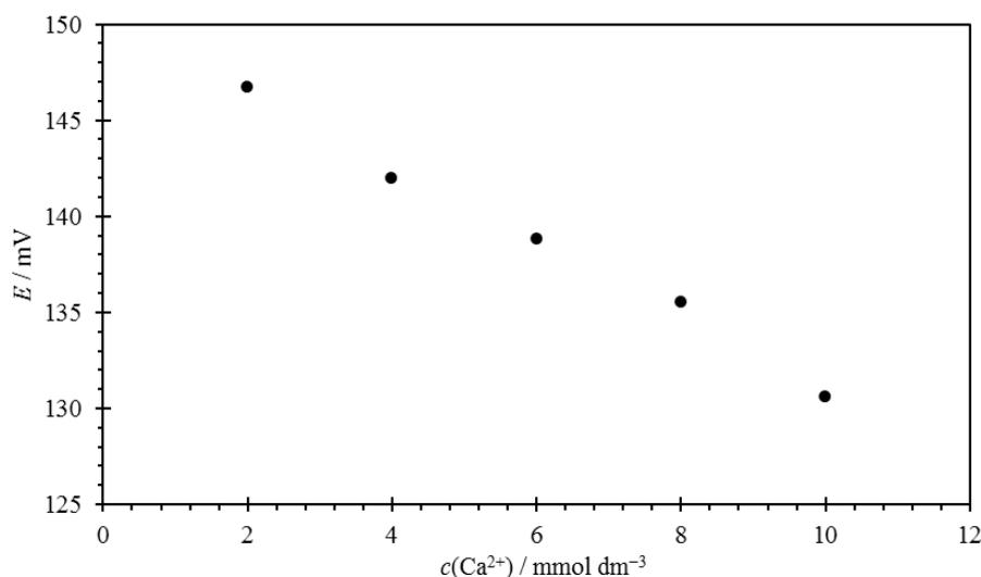
Slika 4.11. Ovisnost elektromotivnosti članka sastavljenog od fluoritne S<sub>CrE</sub> i kombinirane elektrode o koncentraciji  $\text{Ca}^{2+}$  iona u otopini NaCl ( $1 \times 10^{-3} \text{ mol dm}^{-3}$ ). Titracija je provedena otopinom  $\text{CaCl}_2$  u atmosferi argona pri  $\text{pH} = 5,0 \pm 0,1$  i  $25 \text{ }^\circ\text{C}$ .
