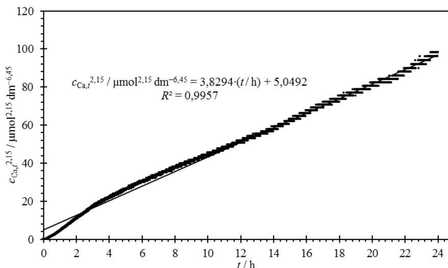
Slika 4.28. Vremenska ovisnosti koncentracije  $Ca^{2+}$  iona tijekom otapanja (111) plohe fluorita određena uz miješanje reakcijske smjese brzinom od približno 600 okretaja u minuti u atmosferi argona pri  $25 \text{ }^\circ\text{C}$ ,  $\text{pH} = 5,0 \pm 0,3$  i  $I_c \approx 1 \times 10^{-3} \text{ mol dm}^{-3}$  koja je održavana stalnom pomoću NaCl.
