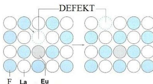
Slika 2.9. Shematski prikaz transfera fluoridnih iona monokristalom lantanova(III) fluorida.<sup>57</sup>
