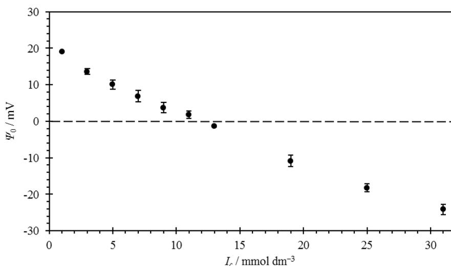
Slika 4.9. Ovisnost površinskog potencijala (111) plohe fluorita o ionskoj jakosti otopine koja je regulirana titracijom s otopinom inertnog elektrolita (NaCl) u atmosferi argona pri  $\text{pH} = 5,0 \pm 0,1$  i  $25 \text{ }^\circ\text{C}$ . Standardna odstupanja odgovaraju trima istovjetnim, ali nezavisnim mjerenjima.
