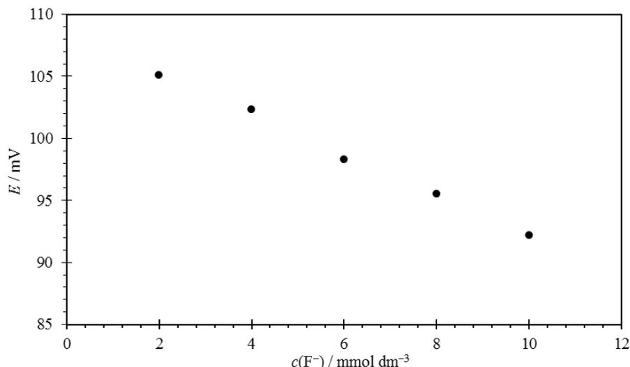
Slika 4.15. Ovisnost elektromotivnosti članka sastavljenog od fluoritne SCrE i kombinirane elektrode o koncentraciji  $\text{F}^-$  iona u otopini NaCl ( $1 \times 10^{-3} \text{ mol dm}^{-3}$ ). Titracija je provedena otopinom NaF u atmosferi argona pri  $\text{pH} = 5,0 \pm 0,1$  i  $25 \text{ }^\circ\text{C}$ .
