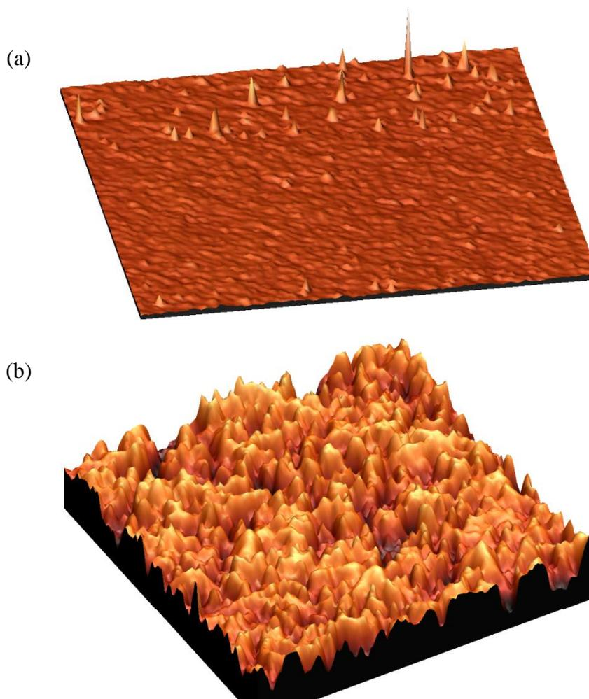
Slika 4.20. 3D AFM prikaz  $10,1 \mu\text{m} \times 10,1 \mu\text{m}$  površine (a) nekorištenog monokristala fluorita i (b) monokristala fluorita korištenog u prethodnim mjerenjima s fluoritnom SCrE.
