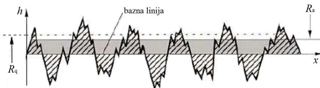
Slika 2.13. Visinski profil površine nekog uzorka  $h(x)$  duž bazne linije s naznačenom vrijednosti prosječne hrapavosti ( $R_a$ ) i RMS hrapavosti ( $R_q$ ).<sup>64</sup>
