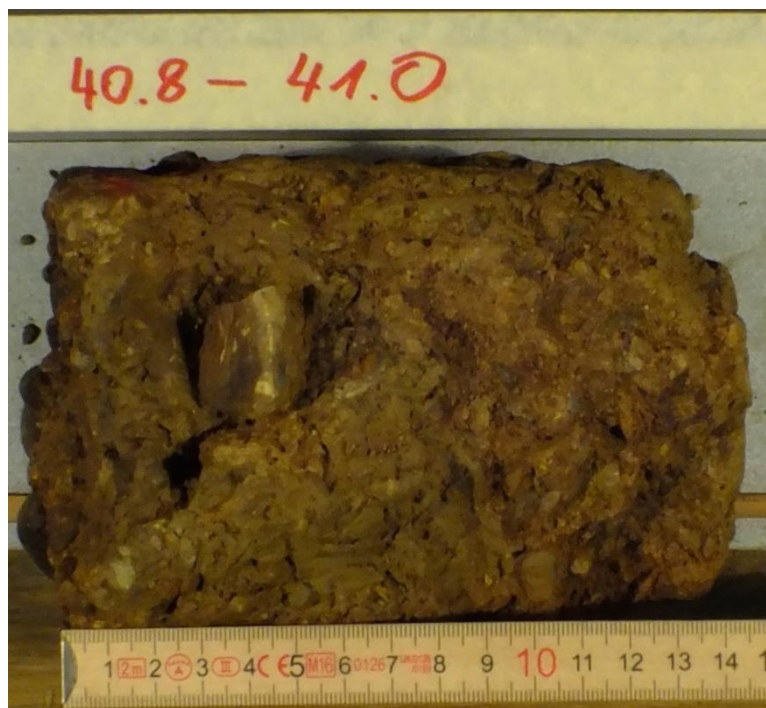
Slika 10. Dio jezgre s dubine 40,08-41 m s vidljivim klastom kvarca.
