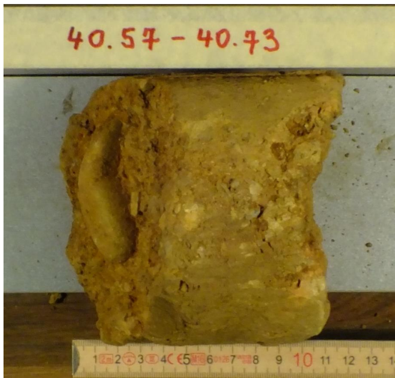
Slika 9. Dio jezgre s dubine 40,57-40,73 m s velikim klastom zelenog škriljavca.
