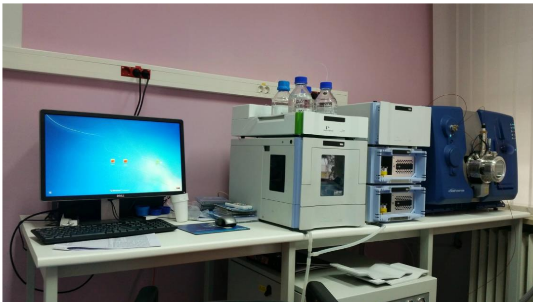
Slika 6. Vezani sustav tekućinski kromatograf–spektrometar masa u Zavodu za javno zdravstvo „dr. Andrija Štampar“ u Zagrebu.
