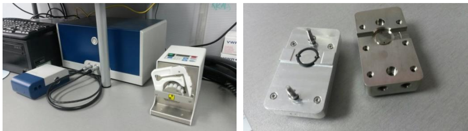
Slika 3.2.6.1. a) kvarc-kristalna mikrovaga uz praćenje disipacije, b) protočna ćelija, Q-Sense E1 , Biolin Scientific .
