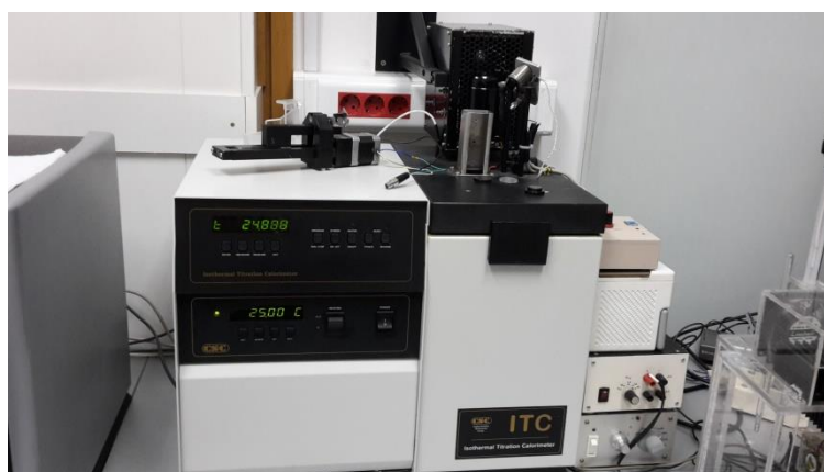
Slika 3.2.3.1. Kondukcijski izotermni titracijski kalorimetar CSC 4200, ITC Scientific Corporation.
