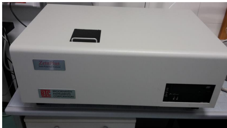
Slika 3.2.2.1. Instrument za mjerenje dinamičkog i elektroforetskog raspršenja svjetlosti ( Brookhaven 90 Plus Particle Size Analyzer i Zeta Potential Analyzer, Brookhaven Instruments Corporation ).
