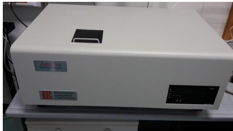
Slika 3.2.2.1. Instrument za mjerjenje dinamičkog i elektroforetskog raspršenja svjetlosti (*Brookhaven 90 Plus Particle Size Analyzer i Zeta Potential Analyzer, Brookhaven Instruments Corporation*).
