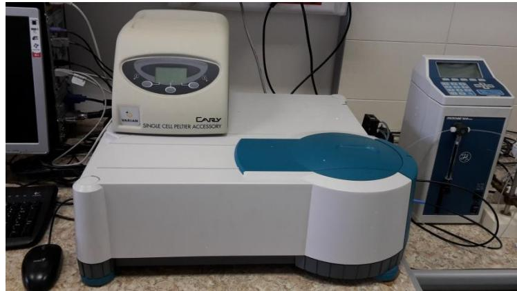
Slika 3.2.5.1. UV/Vis spektrofotometar *Cary 50, Varian.*
