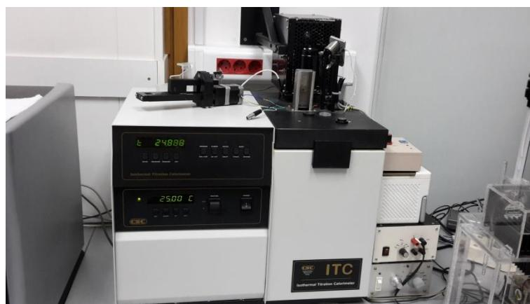
Slika 3.2.3.1. Konduktički izotermni titracijski kalorimetar CSC 4200, *ITC Scientific Corporation*.
