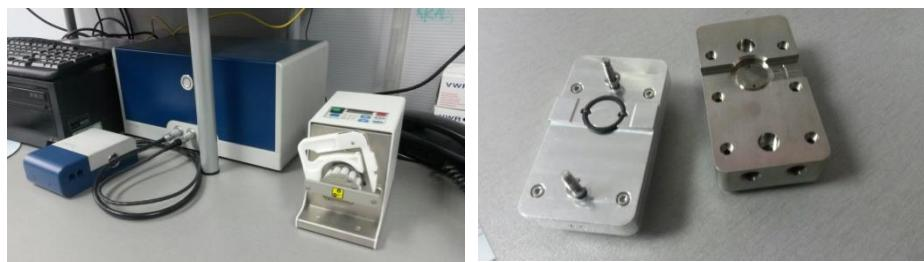
Slika 3.2.6.1. a) kvarc-kristalna mikrovaga uz praćenje disipacije, b) protočna čelija, *Q-Sense EI, Biolin Scientific*.
