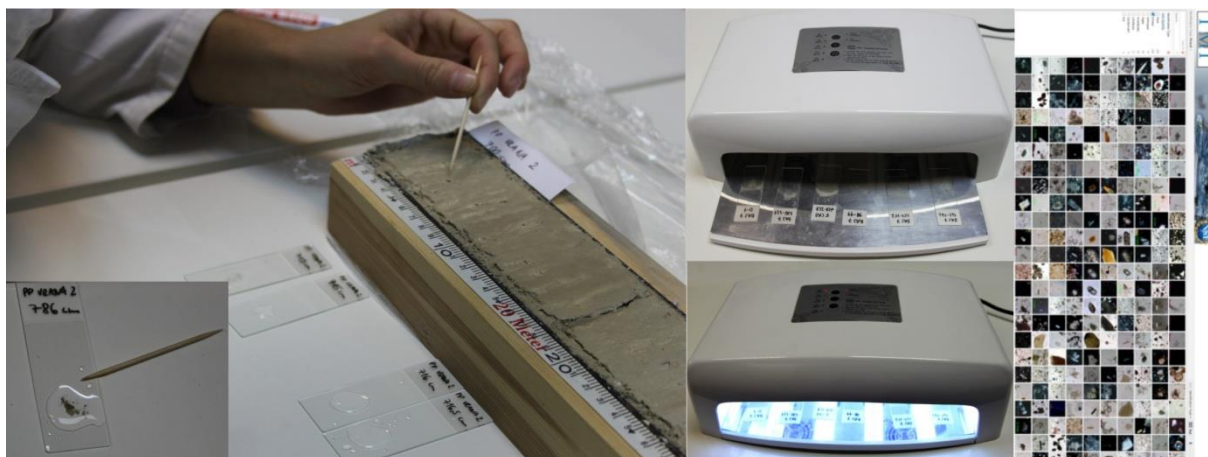
Slika 49 Izrada „smear slide“ preparata za mikroskopsku analizu nekonsolidiranih uzoraka, pomoću UV lampe i interpretacija podataka uz pomoć TMI baze.
