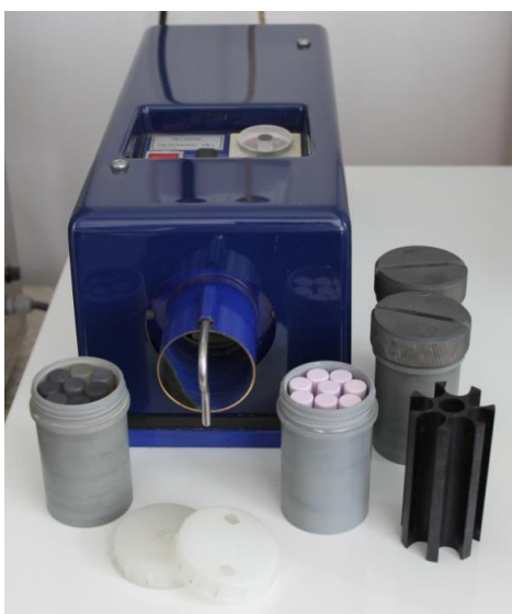
Slika 56 McCroneov mikronizirajući mlin s odgovarajućim priborom za usitnjavanje uzoraka.
