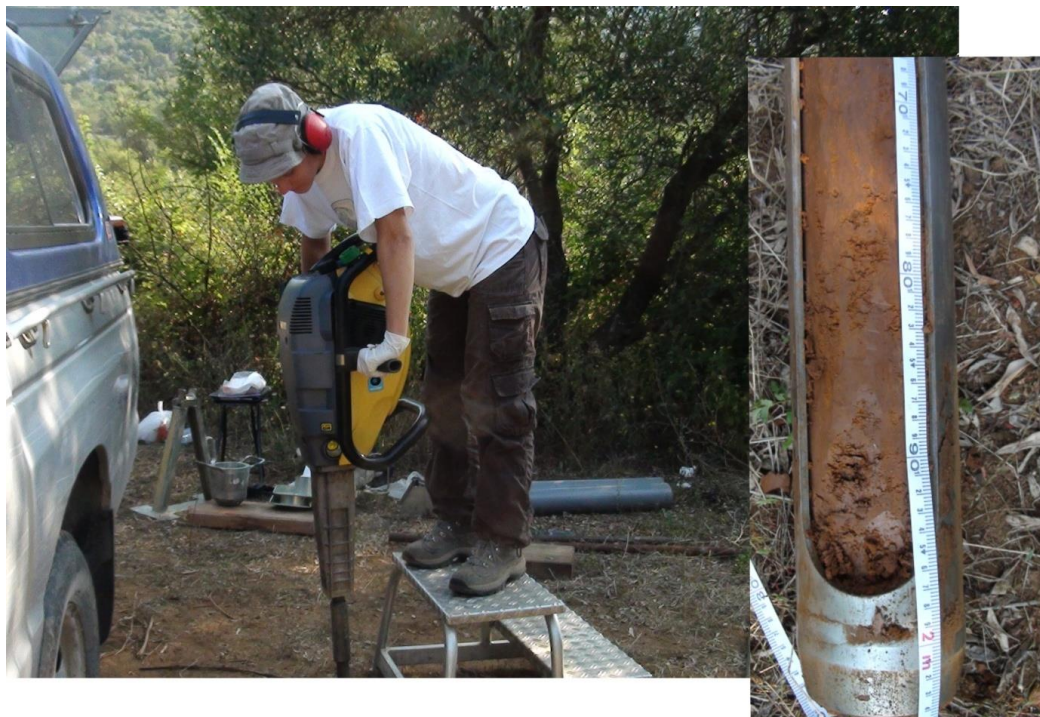
Slika 44 Uzorkovanje uz jezero Crniševo (Baćinska jezera) pomoću udarne bušilice i prikaz dijela profila (BAJ-10), dublji dio s crvenicom.
