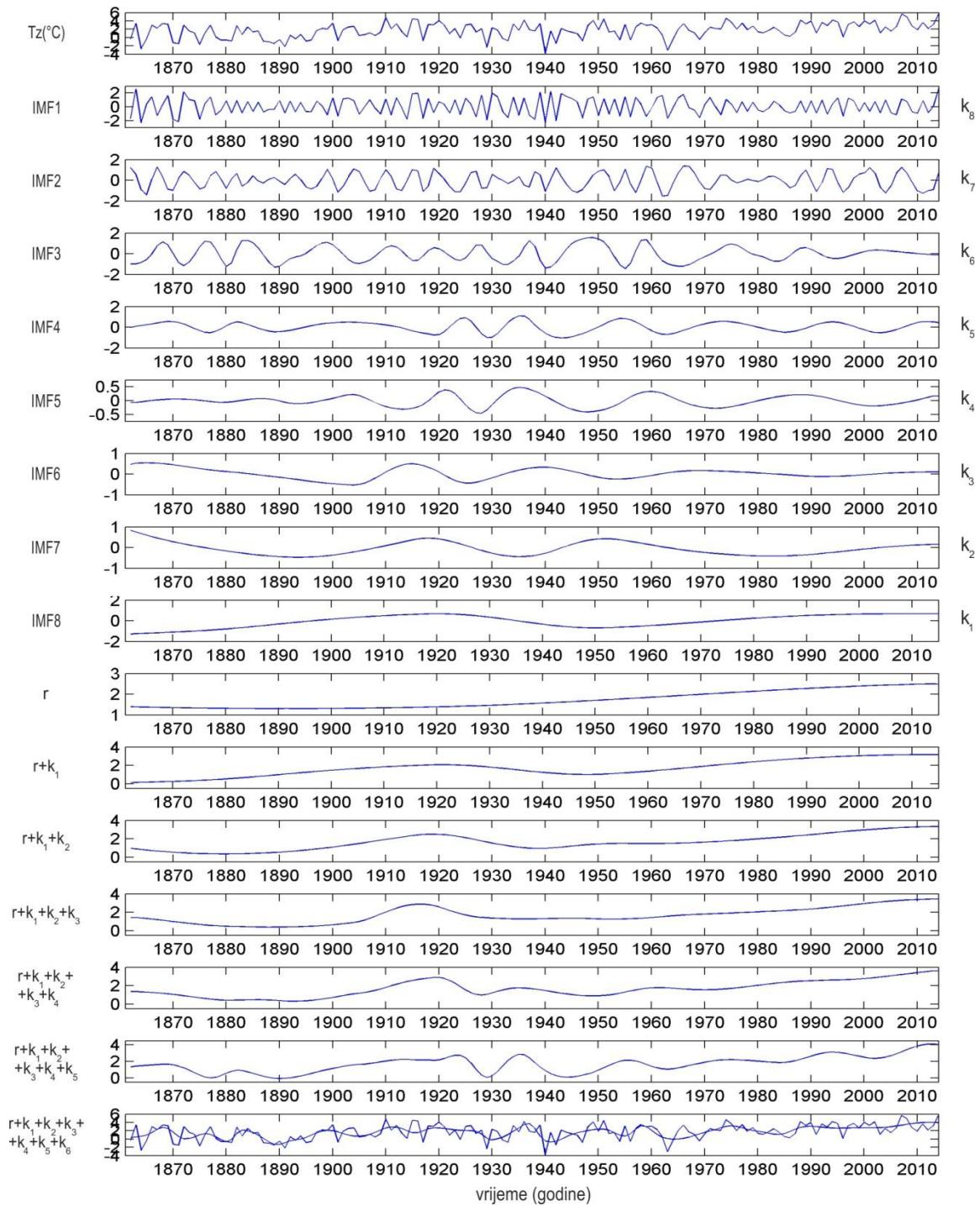
Slika D1. Vremenski niz zimskih srednjaka temperature, IMF dobivene primjenom EMD metode na taj niz, reziduum  $r$  te kumulativne sume reziduumu i odgovarajućih komponenti ( $r+k_1, r+k_1+k_2\dots$ )
