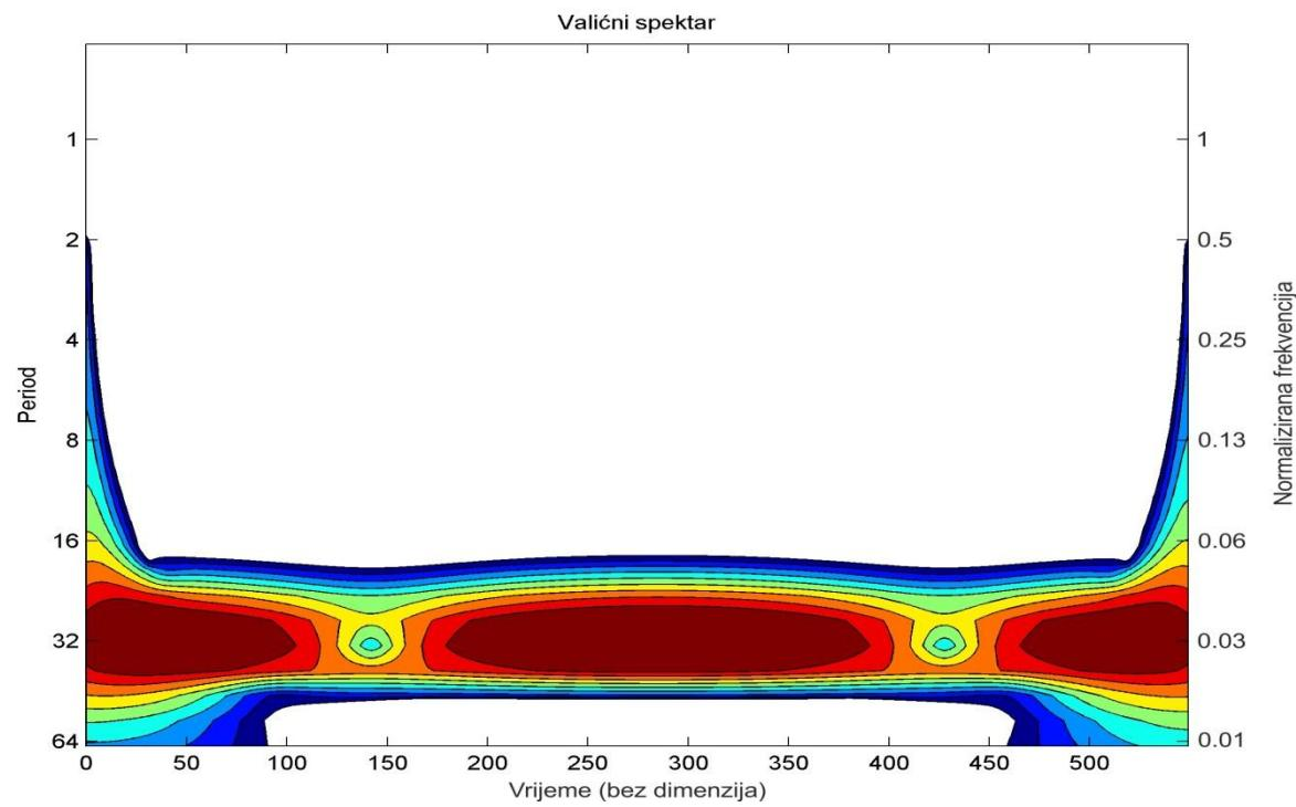
Slika 15. Valični spektar niza prikazanog na slici 14. Metoda ne uspijeva identificirati dvije zasebne harmonijske komponente.
