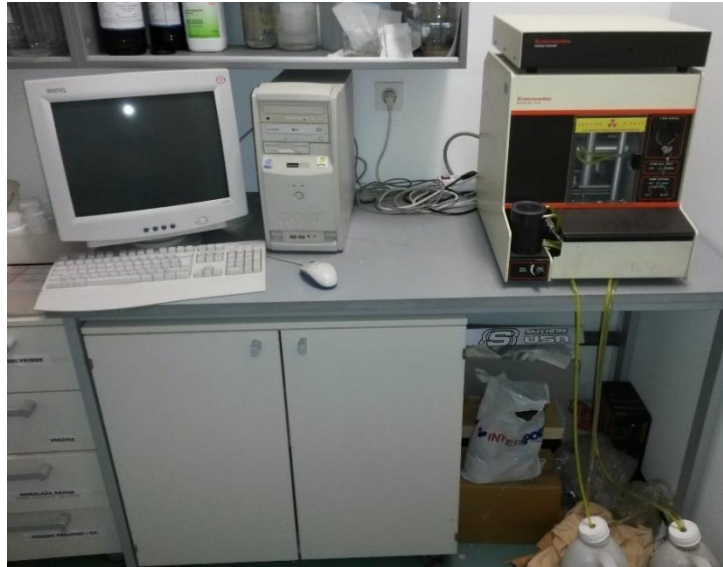
Slika 8 Sustav za granulometrijsku analizu SediGraph 5100 koji se sastoji od analizatora, sučelja i računala. Slika je fotografirana u laboratoriju Geološko-paleontološkog zavoda Geološkog odsjeka Prirodoslovno-matematičkog fakulteta sveučilišta u Zagrebu.
