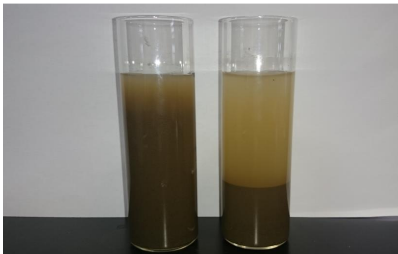
Slika 11. Prikaz sedimenta u kivetama prije centrifugiranja.
