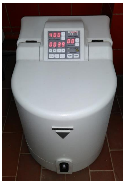
Slika 3.3. Fritsch planetarni kuglični mlin Pulverisette 6 .
