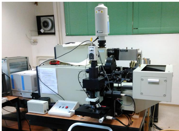
3.9. Horiba T64000 Ramanov spektrometar.
