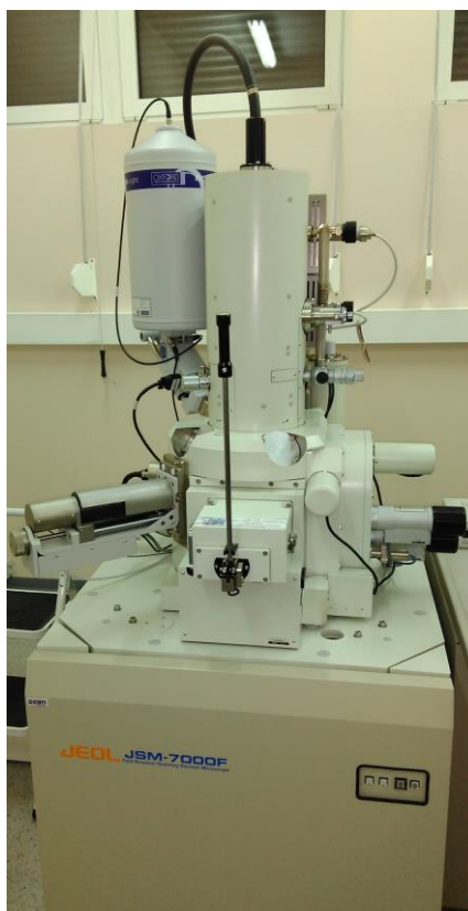
Slika 3.8. Jeol JSM 7000F pretražni elektronski mikroskop.
