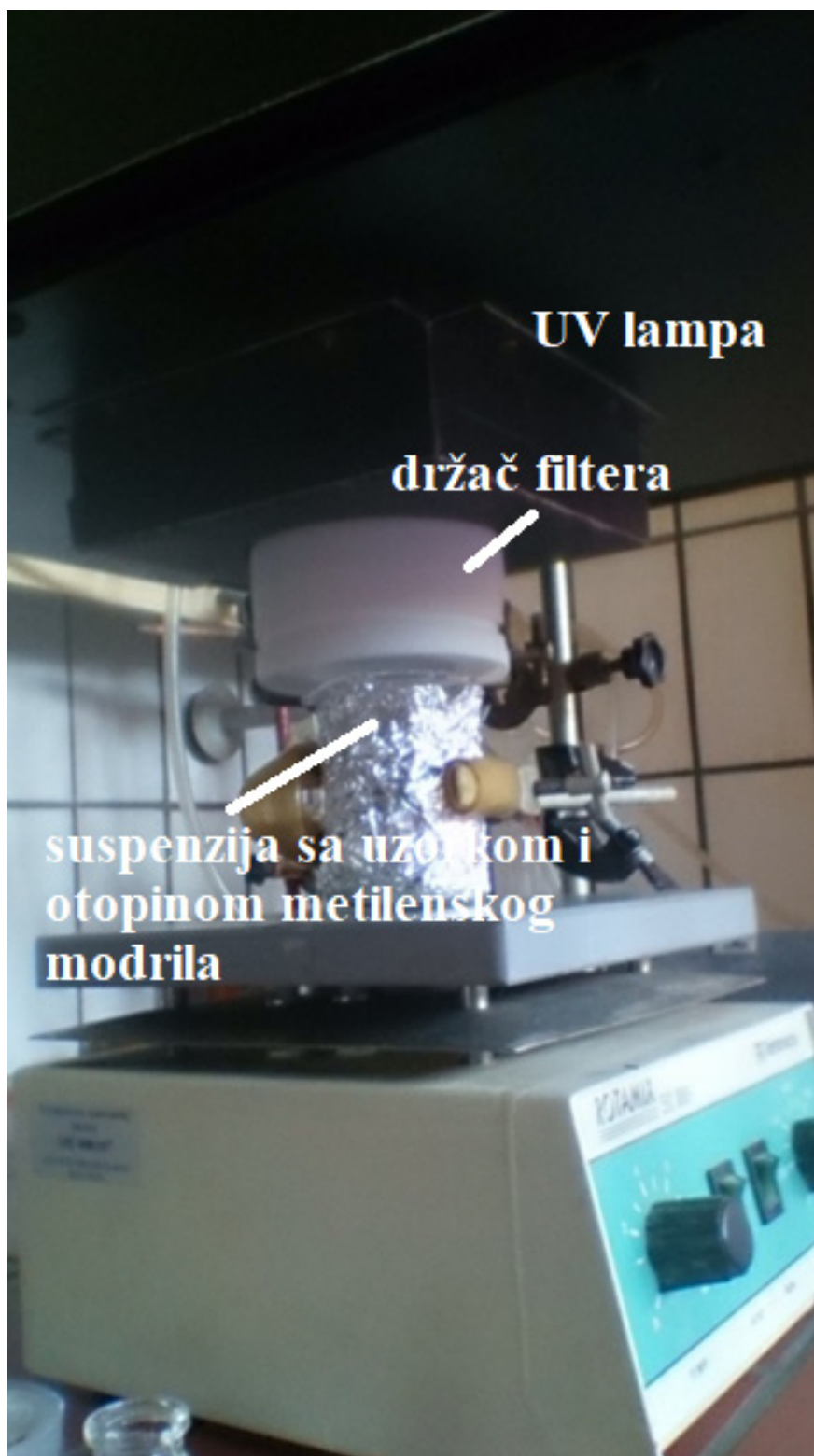
Slika 6. Prikaz postavljenog eksperimenta za određivanje fotokatalitičke aktivnosti
