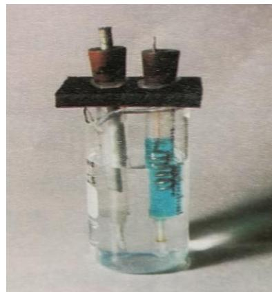
Slika 3. Polučlanci  $Zn^{2+}|Zn$  i  $Cu^{2+}|Cu$  u injekcijskim štrcaljkama uronjeni u otopinu elektrolita (vodena otopina natrijevog klorida).<sup>11</sup>
