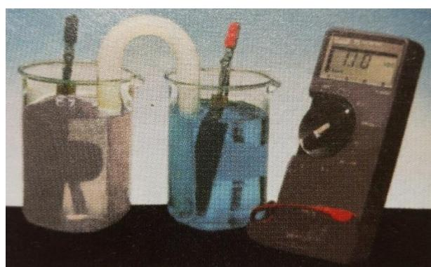
Slika 2. Aparatura za demonstraciju galvanskog članka 'cink-bakar'.<sup>11</sup>
