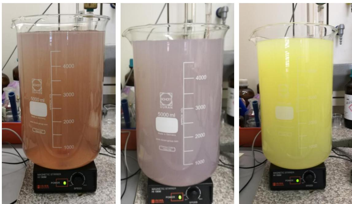
Slika 5. Suspenzija čestica cerijeva oksida tijekom sinteze.
