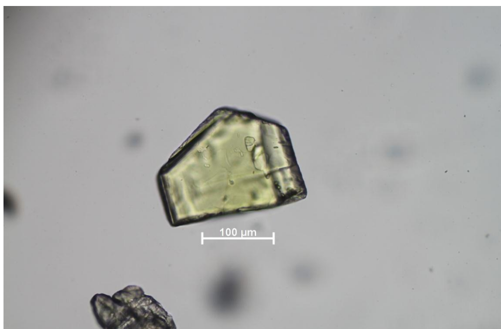
Slika 15. Uzorak MR-6, epidot bez uključenog analizatora
