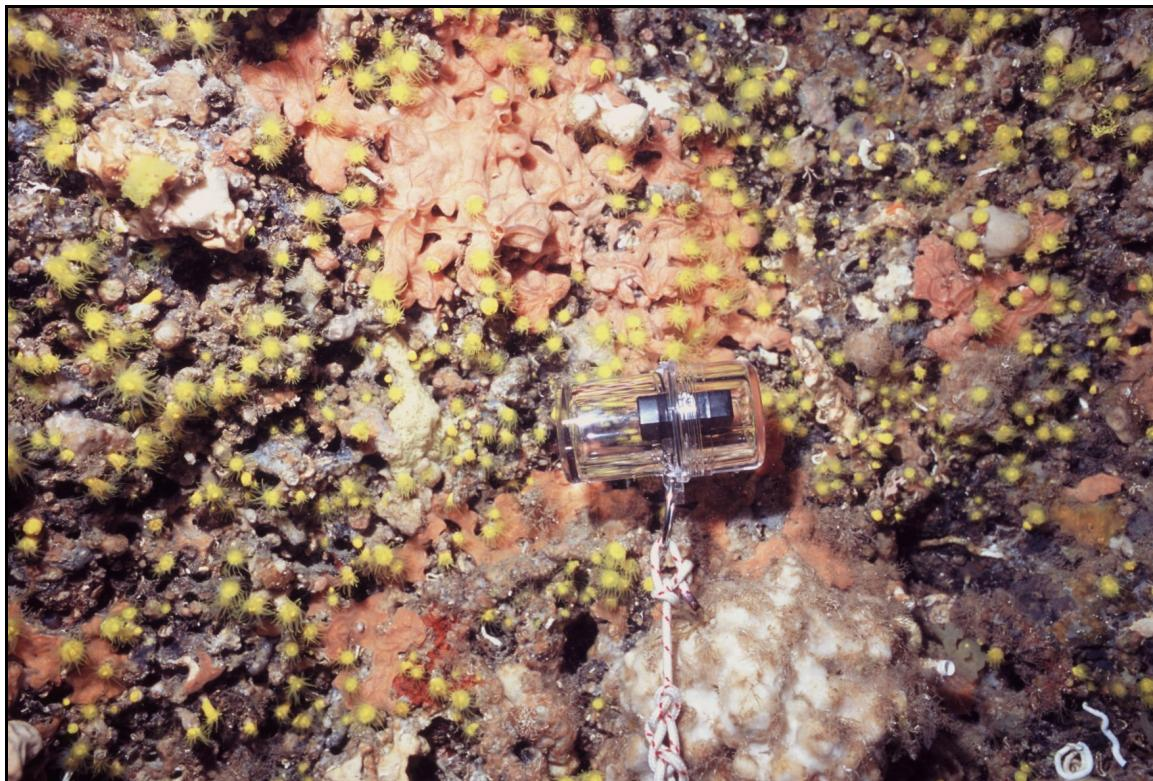
Slika 4. - Uređaj za mjerjenje svjetlosti Onset computers® postavljen u biocenozi polutamnih špilja
