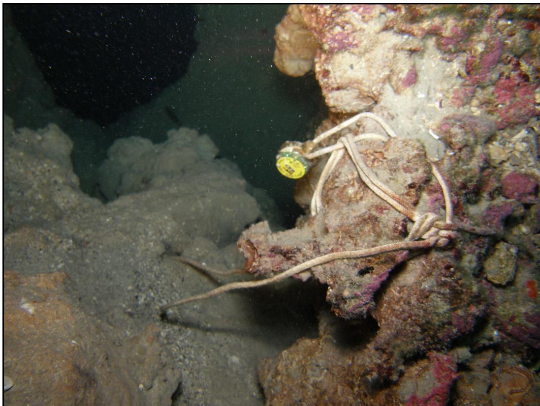
Slika 6. - Uređaj za mjerjenje temperature (data logger) Onset computers® u jami na Iškom Mrtovnjaku, na 10,5 m dubine
