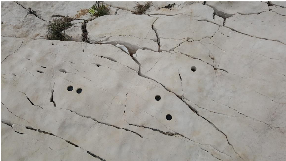
Slika 12: Slojna ploha srednje debelo uslojenih vapnenaca koji su ispresijecani pukotinama što pokazuju jezgre 1280-1284.
