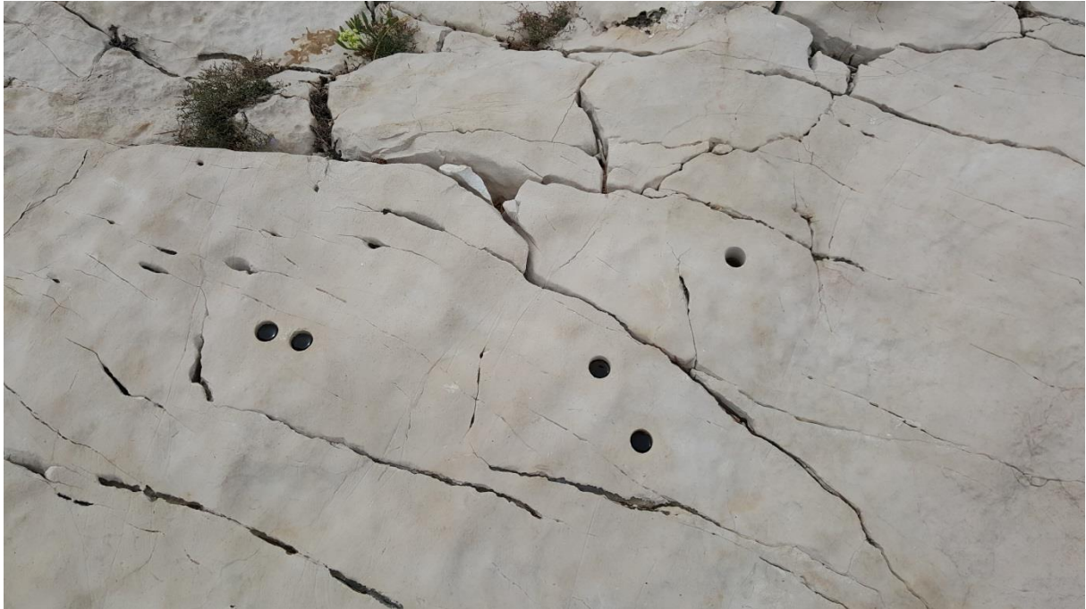
Slika 8: Uvala Likva, slojna ploha paleocenskih vapnenaca s tragovima jezgrovanja (promjer rupice je 2 cm, jezgre Sutivan 1282-1287).
