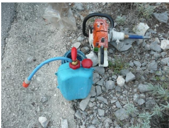
Slika 10: Bušeća aparatura koja se koristi za paleomagnetsko uzorkovanje.
