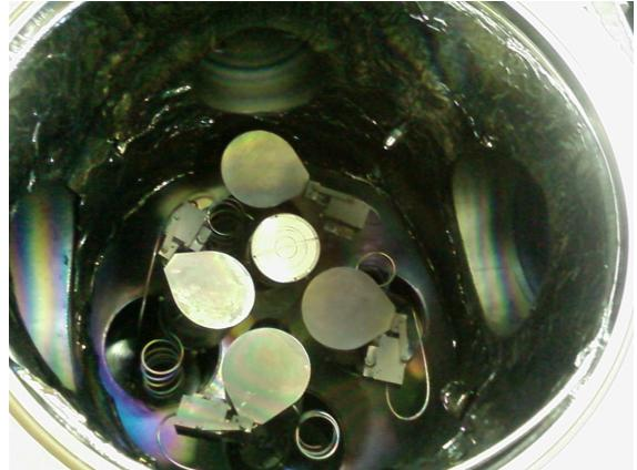
(b) Slika komore u kojoj se događa raspršenje. U sredini se vide 4 kućišta za mete; 3 pokrivena, a 1 otkriveno. Za vrijeme depozicije prikazani se poklopci mogu otvarati i zatvarati po potrebi. Kroz jedan od otvora sa strane unosi se podloga na koju se deponira.
