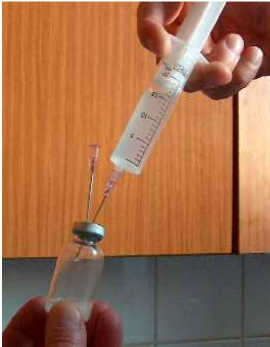
Slika 16. Punjenje fermentacijskih boica uzorkom, potrebne su 2 igle.
