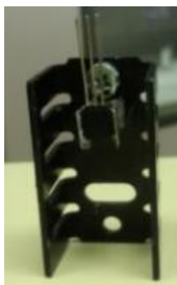
Slika 30. Hladnjak za tranzistor
