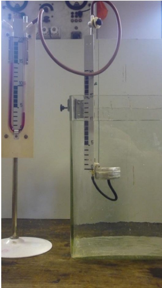
Slika 4.18. Hidrostatski tlak u tekućini
