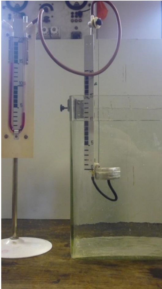
Slika 4.18. Hidrostatski tlak u tekućini
