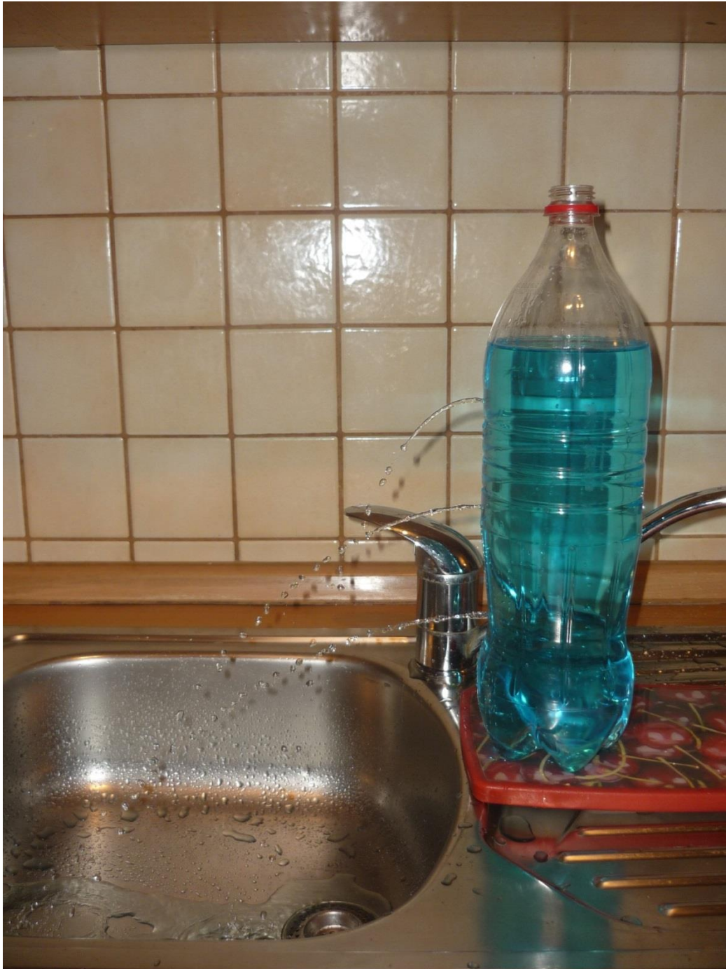
Slika 4.24. Ovisnost hidrostatskog tlaka o dubini
