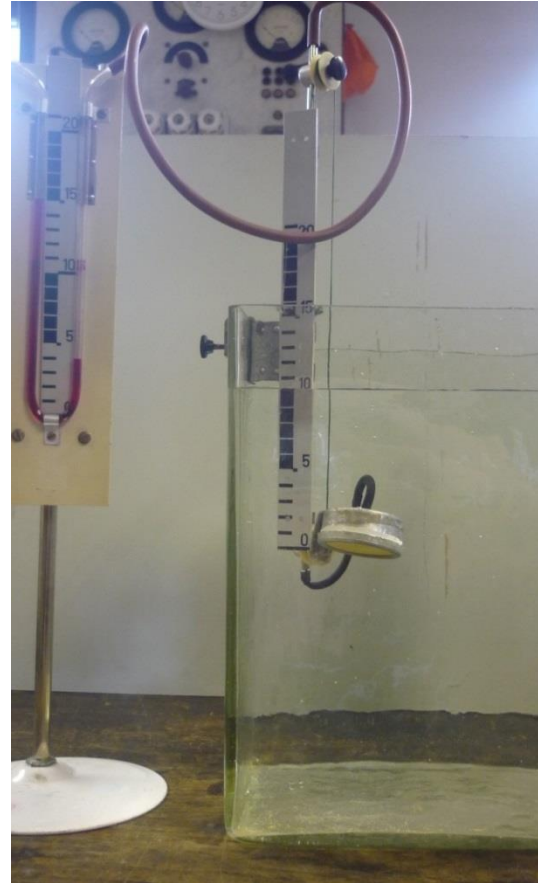
Slika 4.21. Hidrostatski tlak u tekućini – promjena smjera
