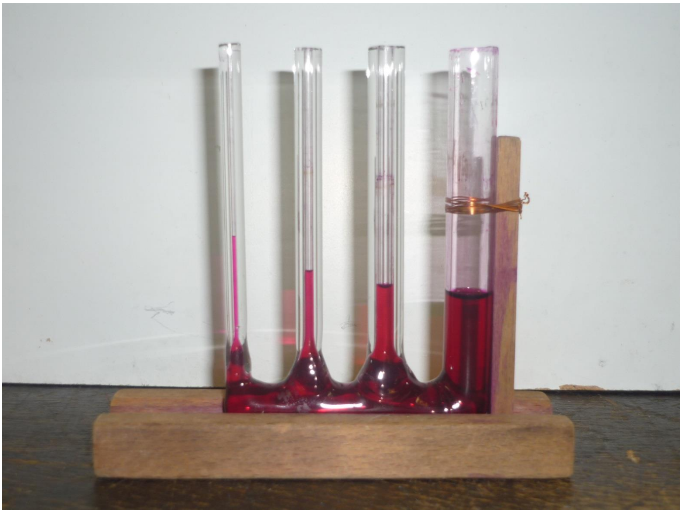
Slika 4.1. Spojene cijevi različitog promjera u kojima se nalazi obojeni alkohol
