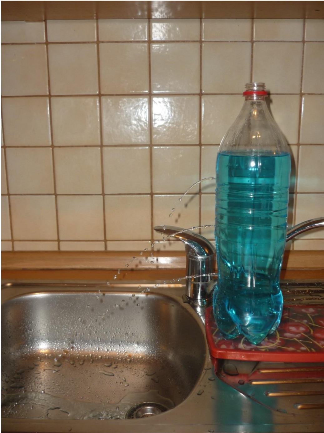
Slika 4.24. Ovisnost hidrostatskog tlaka o dubini
