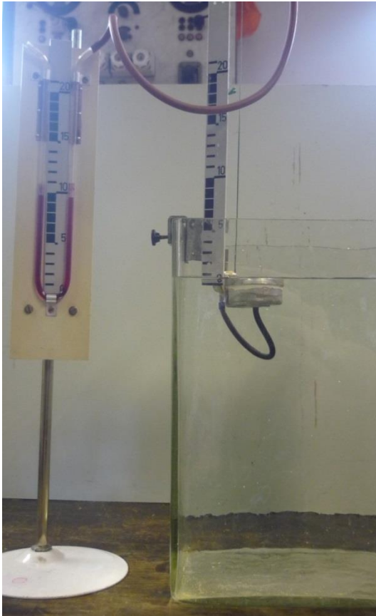
Slika 4.14. Manometar spojen na stalak na kojem se nalazi pomična opna
