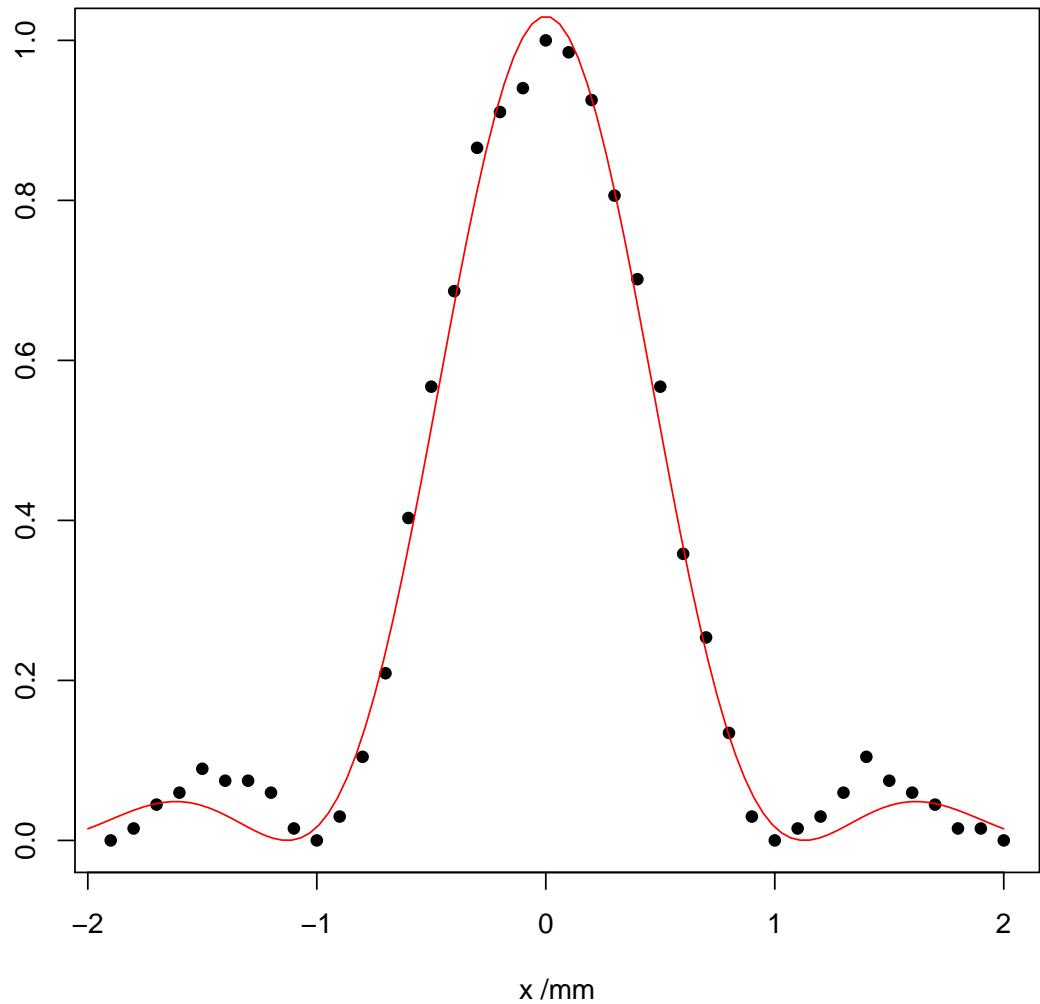
Mjerenja prikazuju promjenu intenziteta ogibne svjetlosti prema intenzitetu nultog maksimuma.
