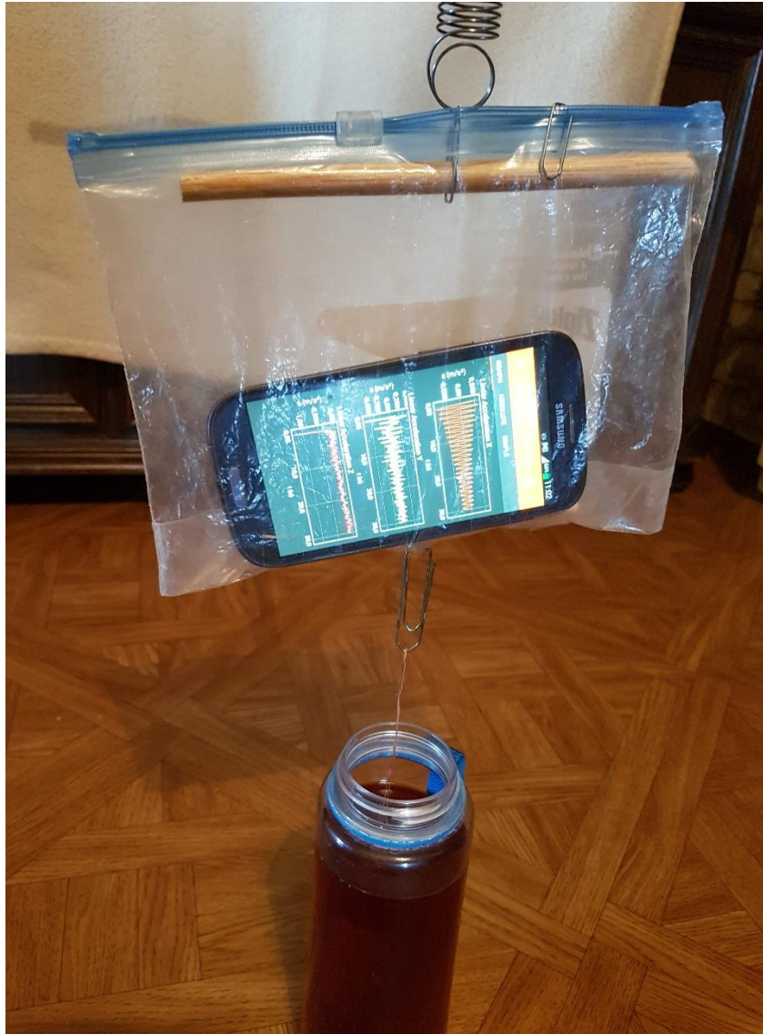
Slika 38: Prigušenje titranja u vinskom octu
