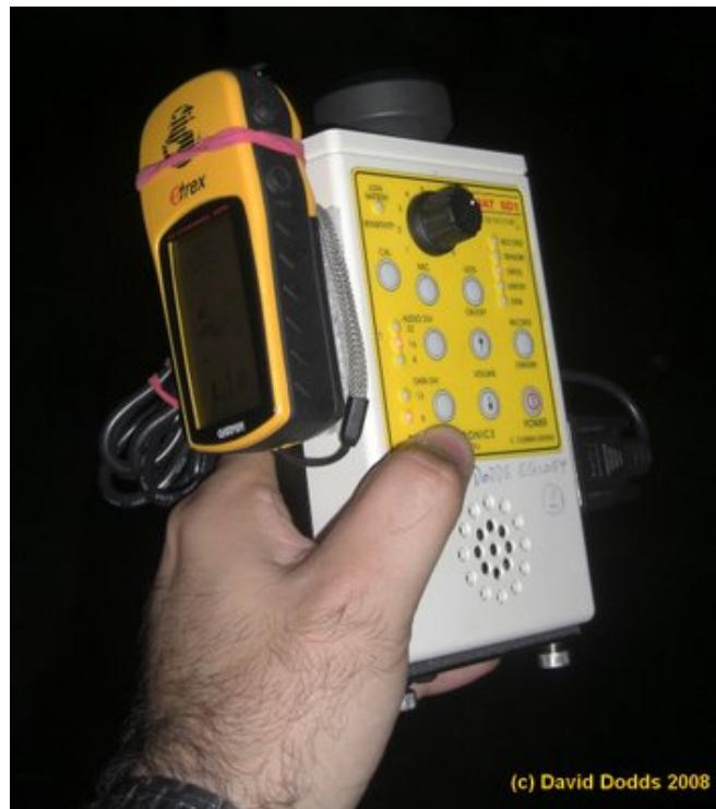
Primjer *time expansion* bat detektora
